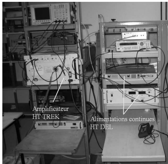
Figure V-7 : Visualisation des différents équipements électriques : alimentations et amplificateurs HT, GBF et oscilloscope.
