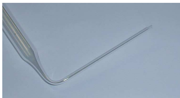
Figure XI-7: Photographie de la prise de pression totale en verre.
