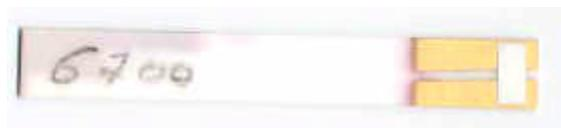
Figure B.12: Photo d'un capteur pour la caractérisation de l'élément sensible
