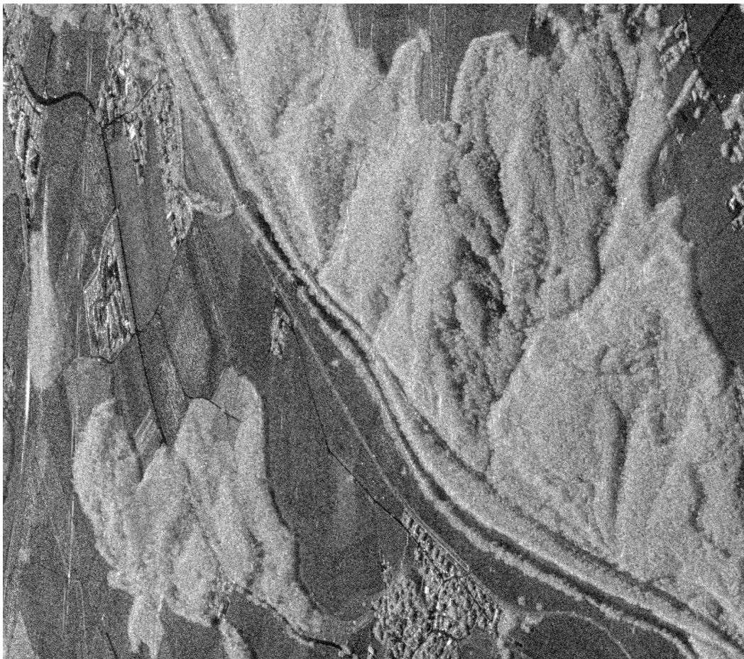
Fig. 1: Image de puissance (SPAN) de la zone de test issue de la scène « Trauntstein » acquise par le capteur ESAR du DLR (Centre Aérospatial Allemand) en bande L.
