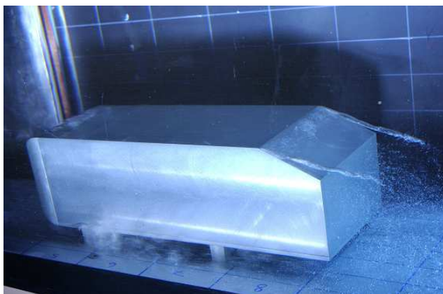
figure 1-14: Visualisation des tourbillons de bord par cavitation (Beaudoin et al. [7])
