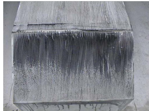
figure 1-18: Photographie des lignes de frottement sur la lunette arrière (Lienhart et Becker [48][49][50])
