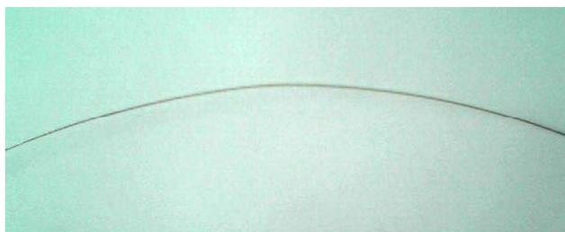
**Figure 5.12 :** Courbure du composite filamentaire SCS-6/Ti6242S brut d'EGV
