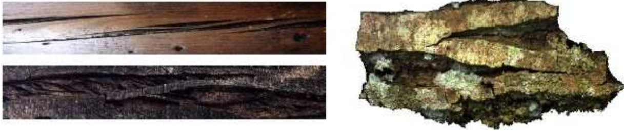
FIG. 10.4 – Les déchirures tendent à s'entrelacer (images réelles).
