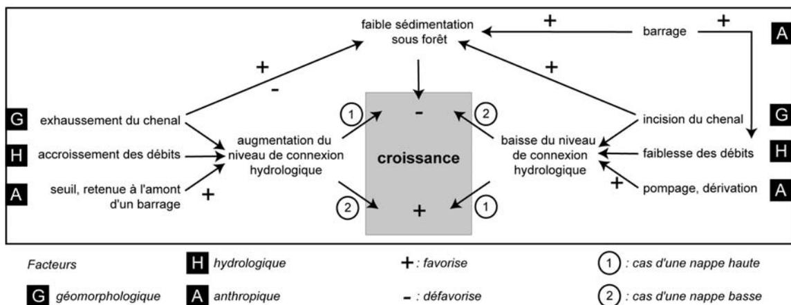
**Figure C.3 – Exemple d'interactions complexes entre facteurs de contrôle : modèle conceptuel simplifié des facteurs de contrôle de la croissance ligneuse en milieu alluvial (note : les interactions biologiques ne sont pas figurées)**
