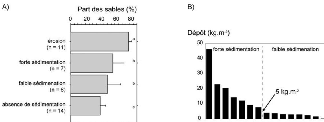
**Figure 3.6 – Caractéristiques des sédiments déposés lors de la crue de novembre 2002, A) relation entre la granulométrie des sédiments de surface et les apports de sédiments lors de la crue, les lettres (a, b et c) indiquent les groupes homogènes (ANOVA), B) distribution des masses déposées**
