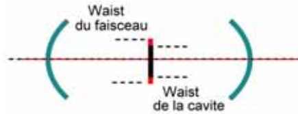
FIG. A.13: La taille du waist du faisceau ( w_0 ) est différent de la taille du waist de la cavité ( w'_0 ).
