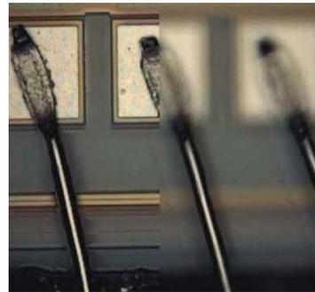
(d) Circuit intégré observé avec un microscope optique classique et avec un microscope optique équipé d'un dispositif "multifocusing" [OHBA ET AL., 2002]
