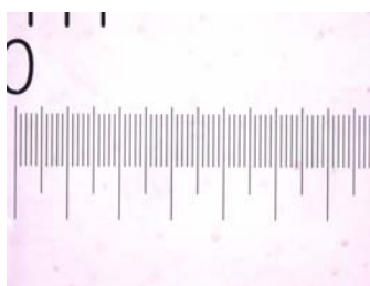
Fig. 1 : lame micrométrique (10x)
