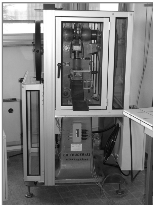
Figure B. 6. Machine à comprimer alternative de type Frogerais OA ®
