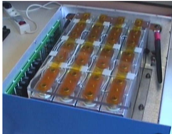
Fig. 3.3. : Module supercondensateur (96F, 56V, 400A)
