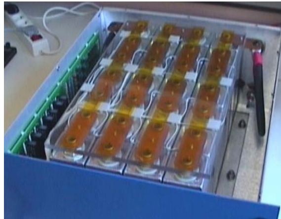
Fig. 3.3. : Module supercondensateur (96F, 56V, 400A)
