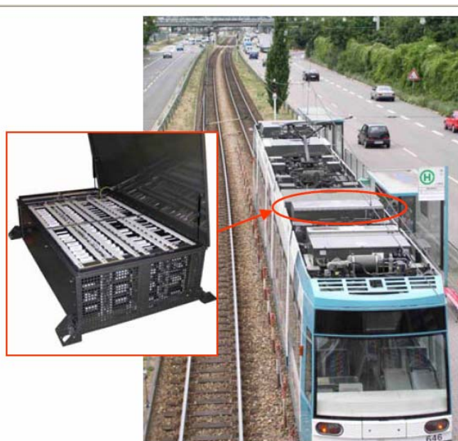
Fig.1.13. : Prototype du tramway fabriqué par BOMBARDIER avec l'utilisation du supercondensateur comme alimentation secondaire
