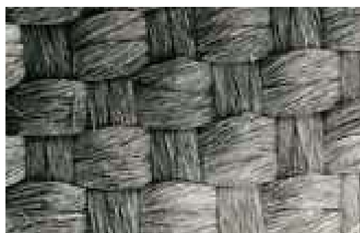
Fig.1.5. : Structure microscopique d'un tissu activé
