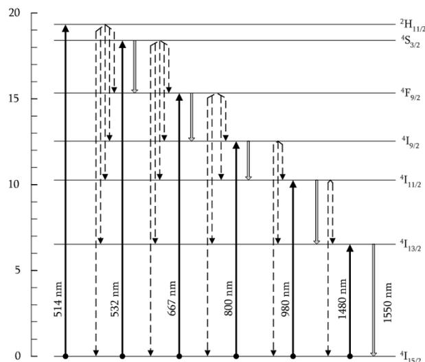
Figure 2.2 : Structure spectroscopique de l'ion erbium.
