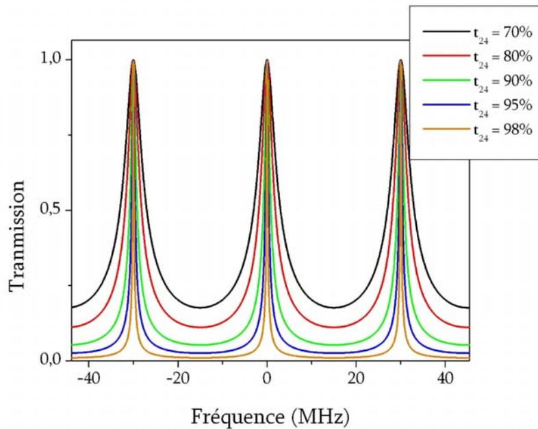
Figure 5.8: Transmission de la cavité froide dans le cadre d'une structure résonnante classique.
