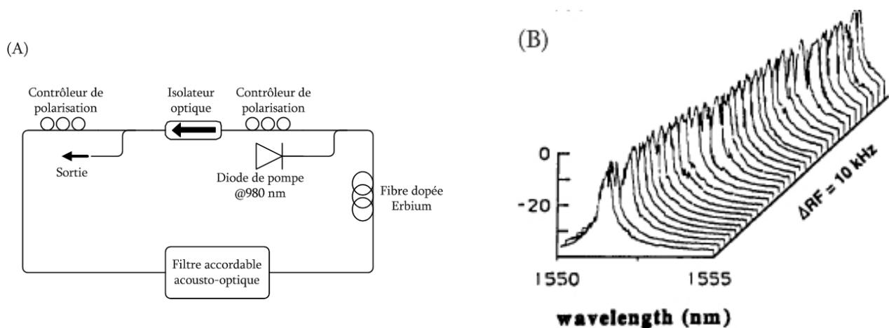
Figure 1.6 : Sch ma exp rimental de la cavit  propos e par Smith et al<sup>[8]</sup>.
