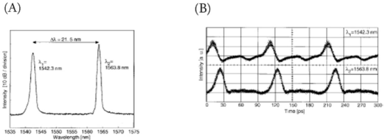
Figure 6.11 : Résultats expérimentaux<sup>[17]</sup> (A) Spectre de sortie du laser. (B) Traces temporelles.
