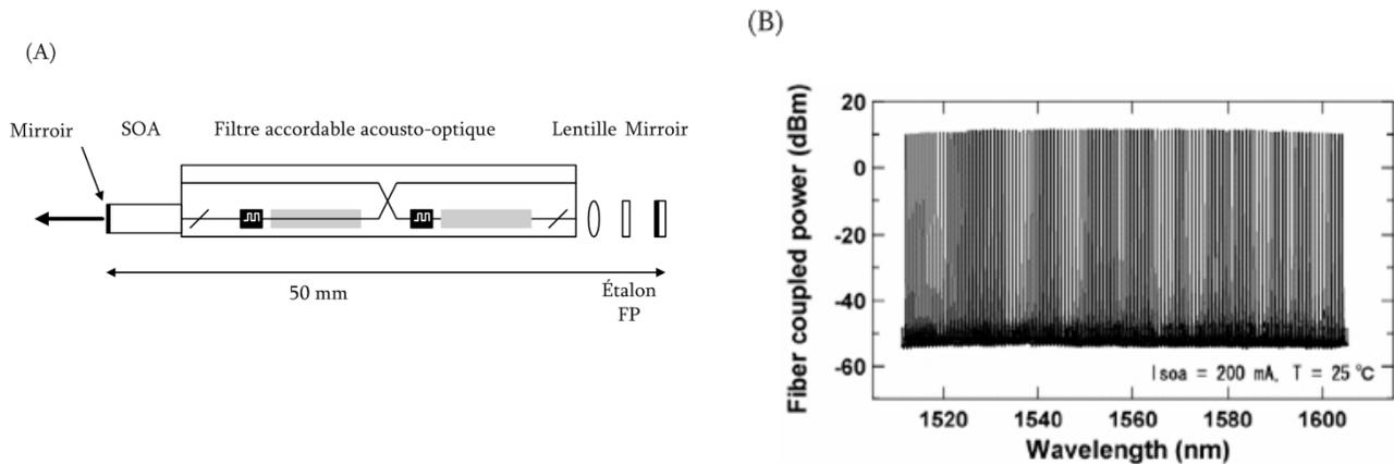
Figure 1.7 : Schéma expérimental de la cavité proposée par Takabayashi et al<sup>[9]</sup>.
