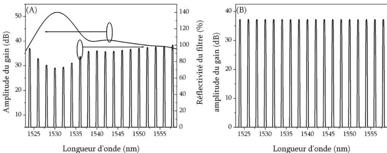
Figure 5.14: Filtrage de la réponse spectrale du gain de l'erbium par une configuration de filtres à amplitude variable. (A) Réponse spectrale du gain et du filtre en fonction de la longueur d'onde. (B) Réponse spectrale du gain après le filtrage par le filtre à amplitude variable.
