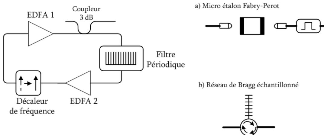
Figure 1.14 : Schéma expérimental d'un laser multi-longueur d'onde CW utilisant un décaleur de fréquence<sup>[21]</sup>.
