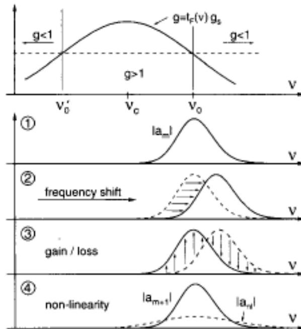
Figure 1.12 : Evolution du spectre dans une cavit  laser utilisant un d caleur acousto-optique<sup>[18]</sup>.
