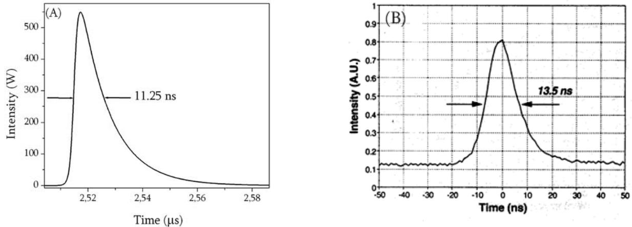
Figure 4.7 : (A) Résultats de la simulation, (B) résultats publiés par Chandonnet et al<sup>[15]</sup>.
