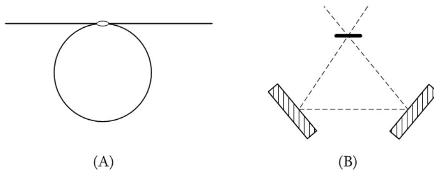
Figure 2.4 : Cavités en anneau<sup>[5]</sup>. (A) Structure utilisée en optique fibrée, (B) Structure utilisée en optique massive.
