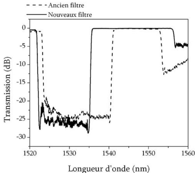
Figure 6.26 : Transmission du filtre passe bande.
