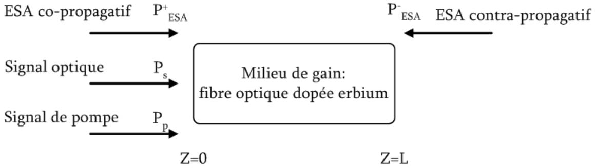
Figure 2.22: Schématisation d'un amplificateur à fibre dopée erbium.
