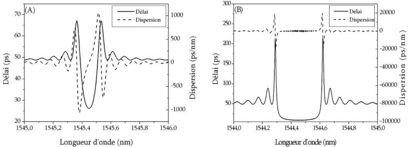
Figure 2.7 : Courbe de délai et de dispersion d'un réseau de Bragg :
