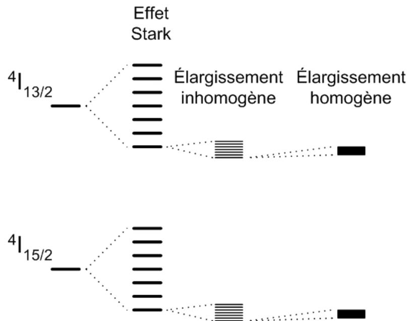
Figure 2.17 : Schéma énergétique décrivant en détails la structure de l'ion  $\text{Er}^{3+}$ <sup>[29]</sup>.
