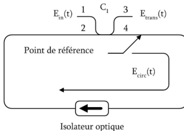
Figure 5.7 : Schématisation d'une cavité froide en anneau.
