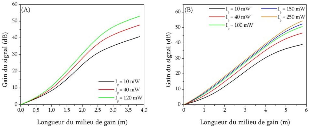
Figure 2.39 : Évolution du gain le long de la fibre dopée erbium. (A)  $\lambda_p = 980$  nm.
