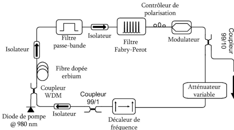
Figure 6.15 : Dispositif expérimental d'un laser fortement multi-longueurs d'onde émettant en régime de modes bloqués<sup>[11]</sup>.
