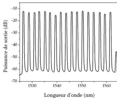
Figure 5.20: Spectre de sortie du laser multi-longueur d'onde.
