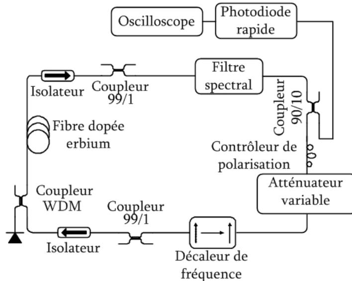
Figure 4.1 : Montage expérimental de la caractérisation du régime de modes déclenchés.
