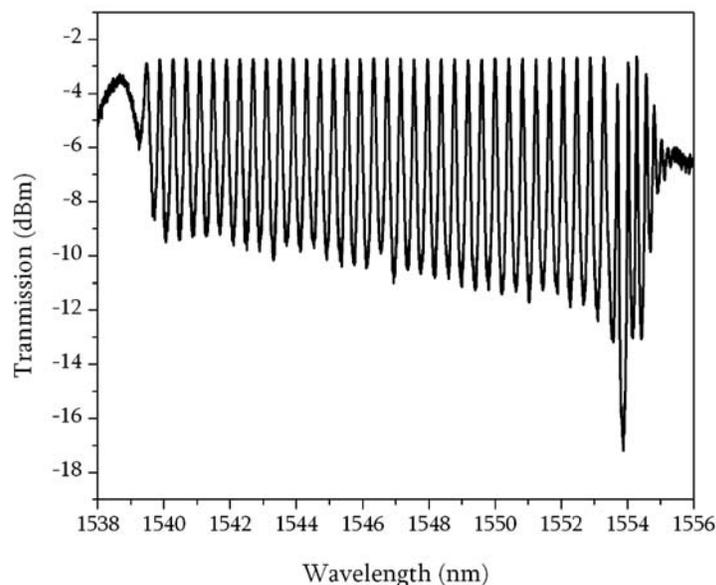
Figure 2.15 : Spectre en transmission d'un filtre Fabry-Perot fibré.
