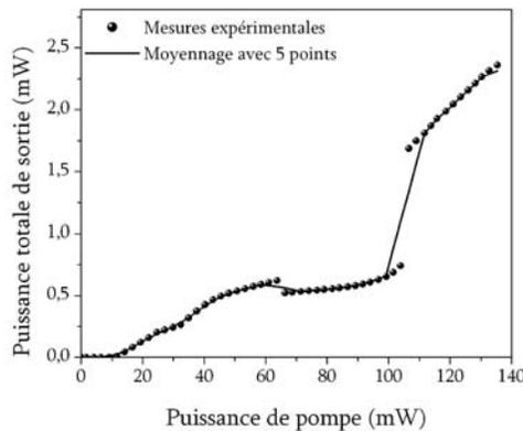
Figure 5.21: courbe PI du laser multi-longueur d'onde.
