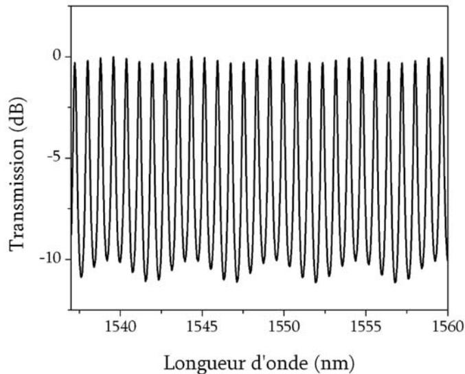
Figure 6.25 : Transmission du micro étalon Fabry-Perot.
