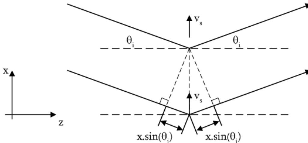
Figure 1.2 : Schéma du calcul de la déviation infinitésimale.
