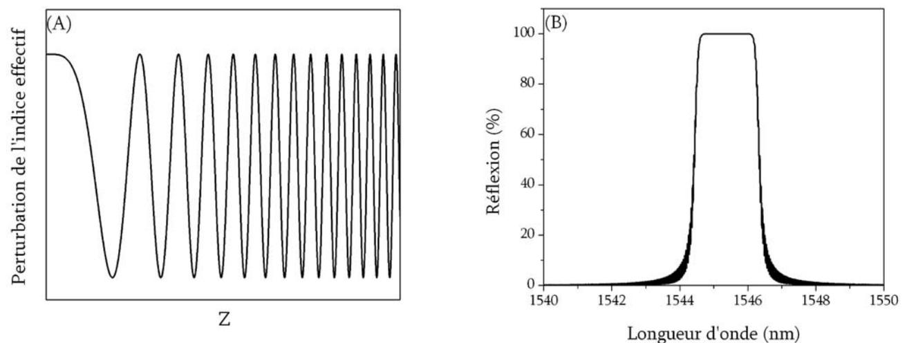
Figure 2.13 : Réseau de Bragg à pas variable : (A) Schématisation de la modulation d'indice, (B) Spectre en réflexion.
