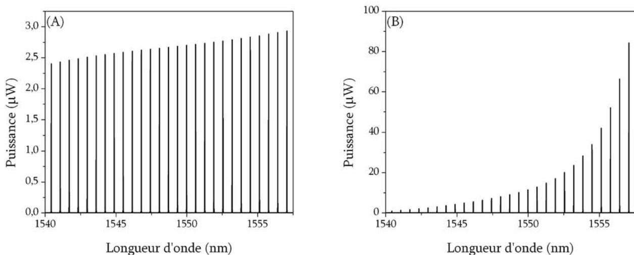
Figure 3.3 : simulation d'une cavité laser utilisant un décaleur de fréquence<sup>[3]</sup>. (A) Simulation avec le décaleur de fréquence, (B) simulation sans le décaleur de fréquence.
