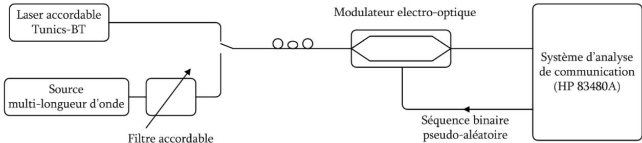
Figure 5.24 : Montage de mesure du diagramme de l'œil.
