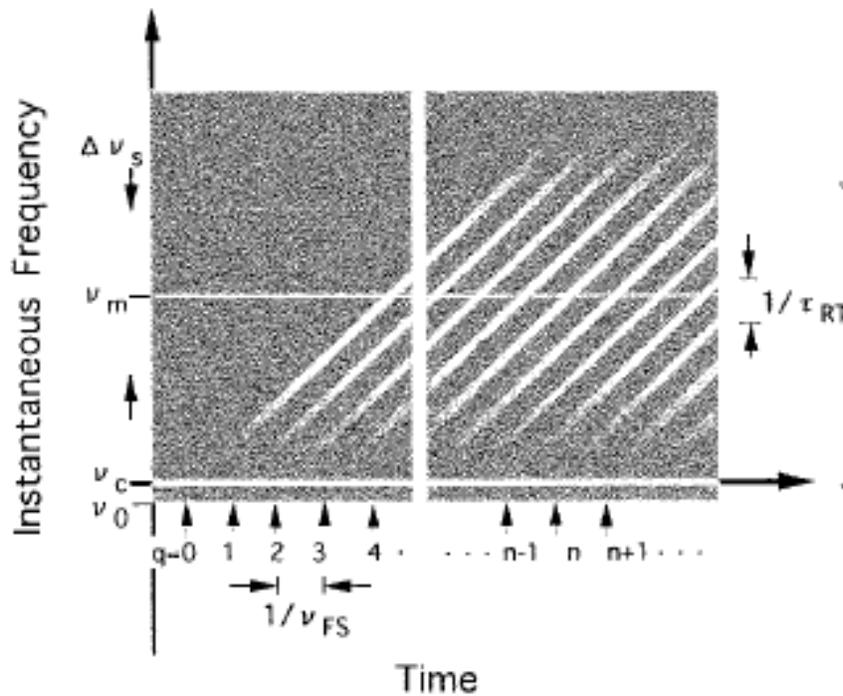
Figure 5.2 : Représentation de la fréquence instantanée du spectre en fonction du temps<sup>[7]</sup>.
