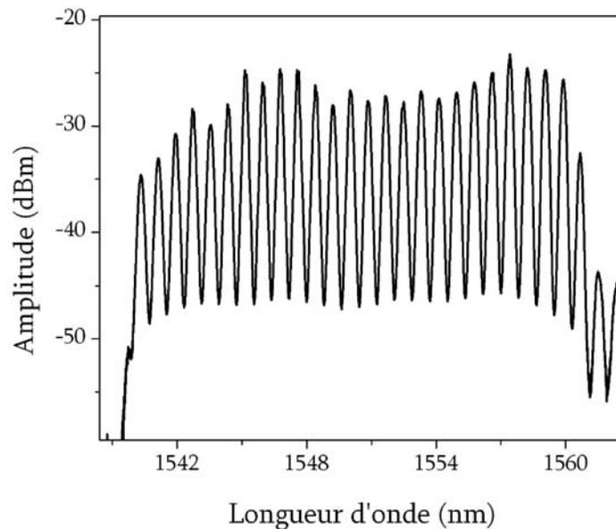
Figure 6.28 : Spectre de sortie du laser multi-longueurs d'onde.
