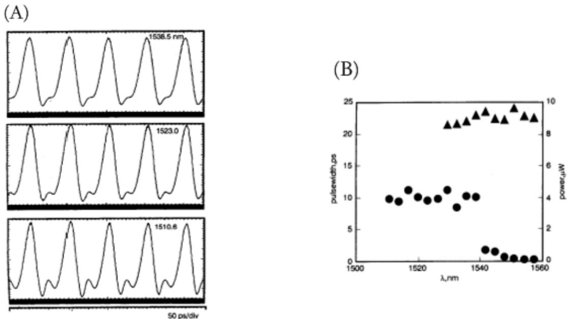
Figure 6.6 : Caractéristiques temporelles du laser<sup>[14]</sup>. (A) Traces temporelles pour 3 longueurs d'onde. (B) Puissance de sortie (cercles) et largeur de l'impulsion (triangles) en fonction de la longueur d'onde.
