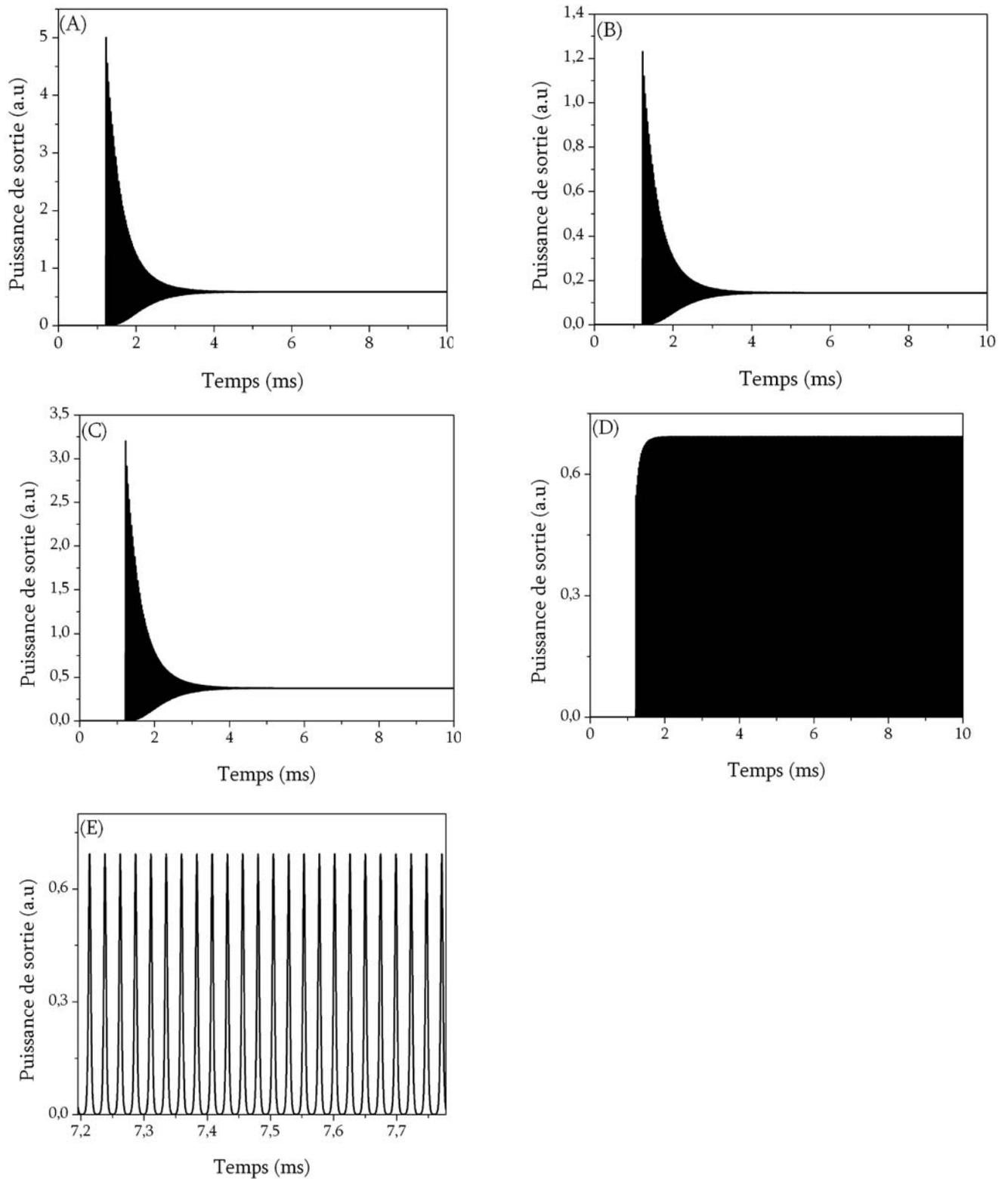
Figure 4.8 : Résultats des simulations numériques. (A) laser *free running*, (B) laser utilisant le filtre uniquement, (C) laser utilisant le décaleur de fréquence uniquement, (D) laser utilisant le filtre et le décaleur de fréquence, (E) élargissement de la figure (D).
