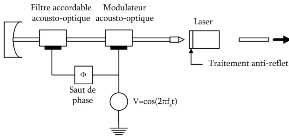
Figure 1.5 : Schéma expérimental de la cavité proposée par Coquin et al<sup>[5]</sup>.
