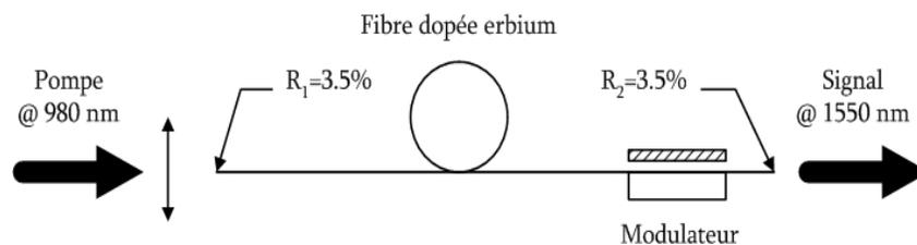
Figure 4.6 : Montage expérimental de Chandonnet et Larose<sup>[15]</sup>.
