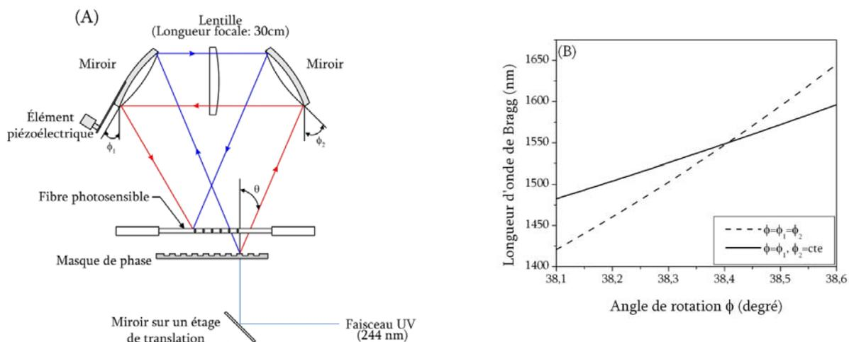
Figure 2.9 : Principe du montage interférométrique de type Sagnac<sup>[22]</sup> :
