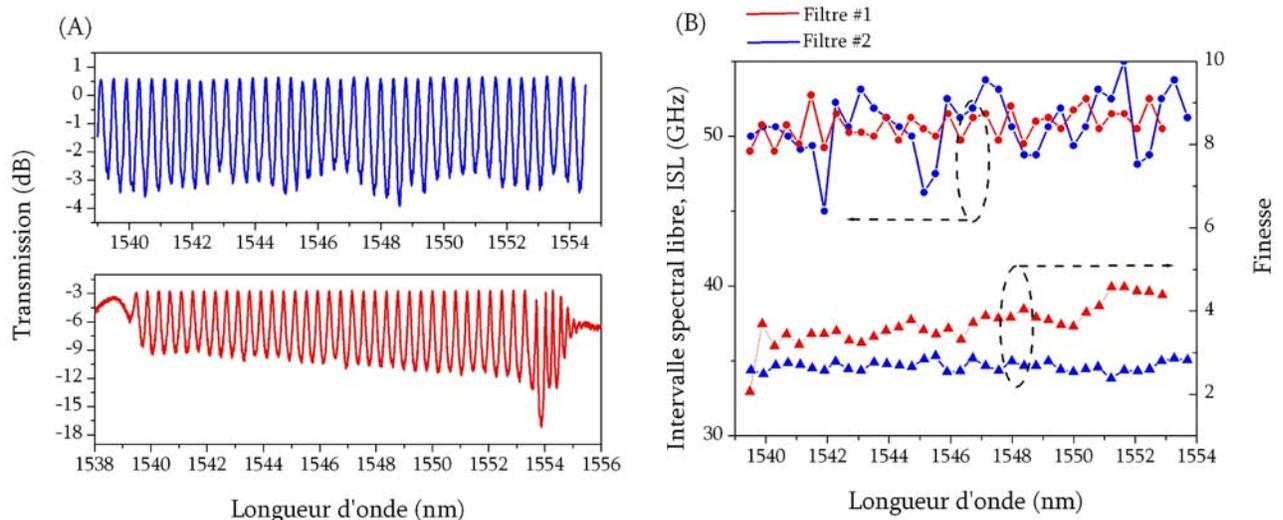
Figure 6.17 : Caractéristiques des deux filtres Fabry-Perot.
