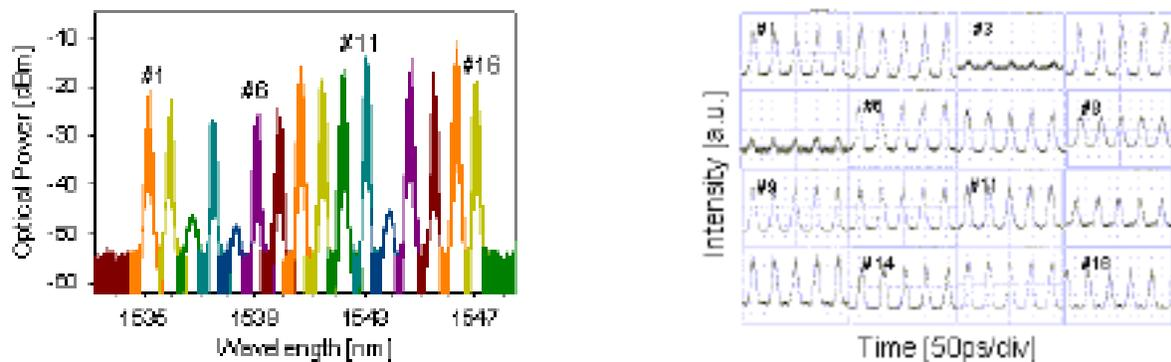
Figure 6.8 : Résultats expérimentaux<sup>[15]</sup>. (A) Spectre de sortie du laser. (B) Traces temporelles pour chaque longueur d'onde.
