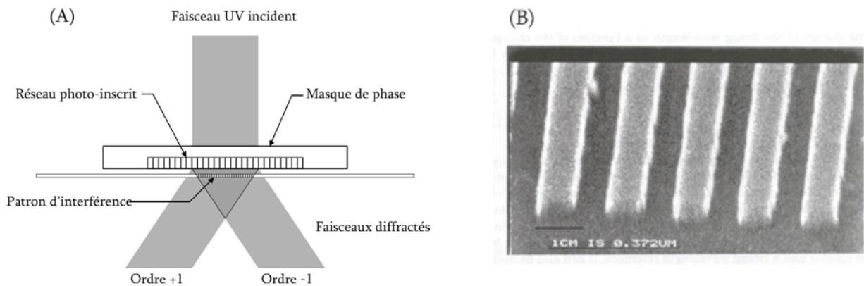
Figure 2.8: Montage à masque de phase<sup>[20]</sup> :
