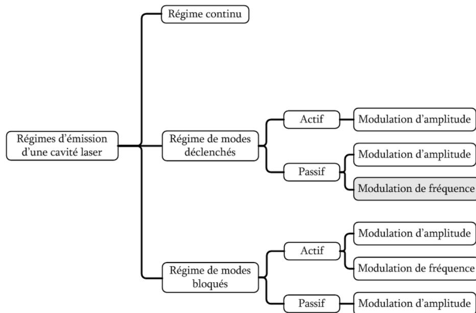
Figure 4.13 : Représentation des différents régimes d'émission d'un laser.
