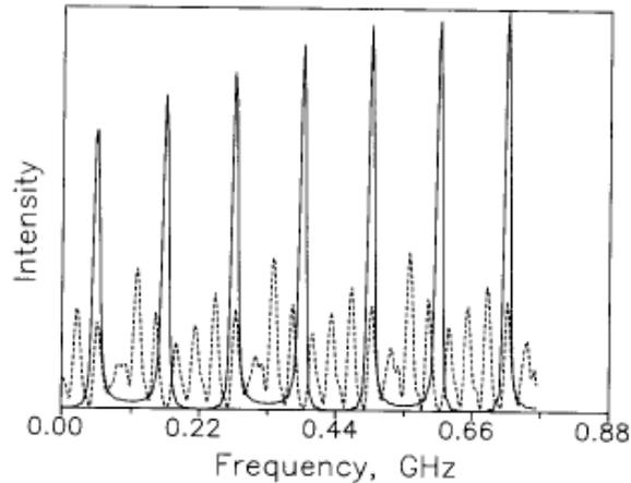
Figure 5.6 : Calcul du spectre correspondant au champ (5.8 b). Pour la trace continue,  $b=10$  GHz, l'ISL vaut 220 GHz et le décalage est de 110 MHz. Pour la trace en pointillée,  $b=10$  GHz, l'ISL vaut  $220 \cdot 0.95$  GHz et le décalage est de 110 MHz.
