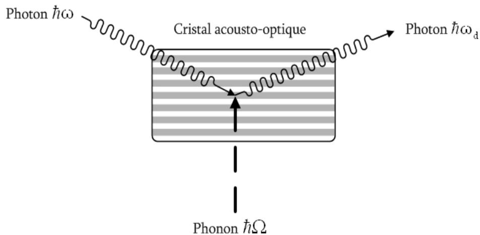
Figure 1.4 : Description quantique de l'effet acousto-optique.
