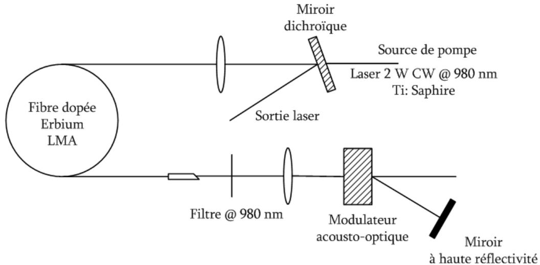
Figure 1.9 : Laser émettant en régime de modes déclenchés utilisant une fibre dopée erbium comme milieu de gain<sup>[10]</sup>.
