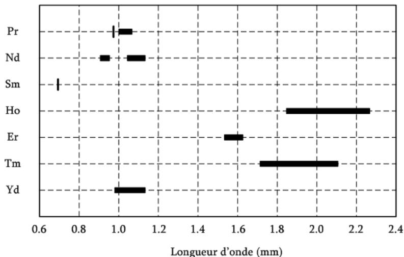
Figure 2.1 : Longueurs d'onde d'émission obtenues avec différents ions de terre rare<sup>[7]</sup>.
