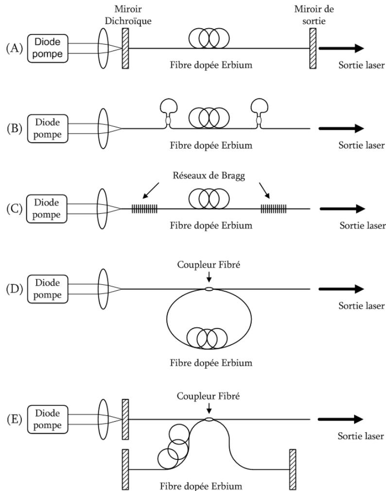
Figure 2.3 : Exemples de cavités couramment utilisées dans la technologie des lasers à fibre<sup>[7]</sup>. (A) Cavité Fabry-Perot, (B) Cavité Fabry-Perot avec des miroirs en boucle, (C) Cavité Fabry-Perot avec des réseaux de Bragg fibrés, (D) Cavité en anneau, (E) Cavité Fox-Smith.
