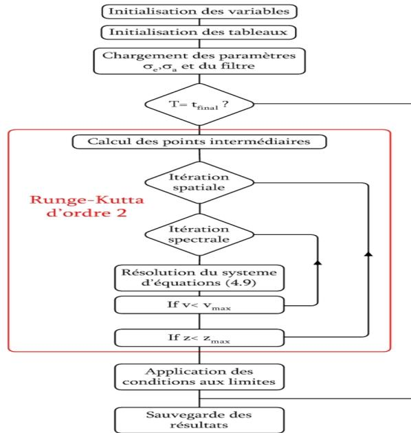
Figure 4.5 : Algorithme de résolution du système d'équations (4.11).
