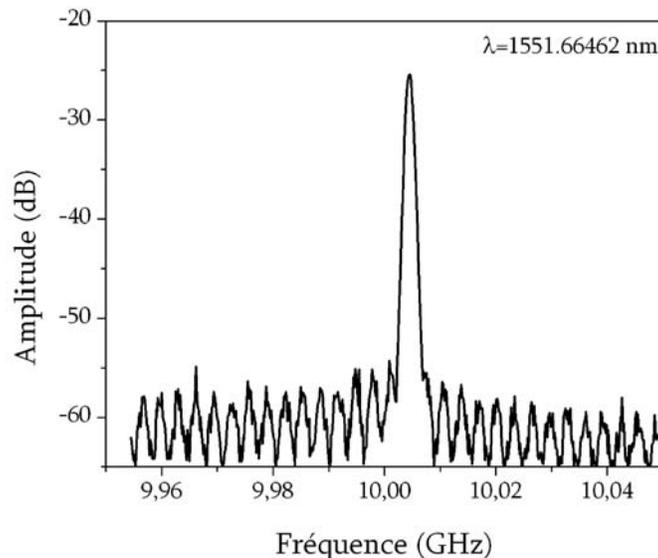
Figure 6.30 : Spectre radiofréquence du champ optique ( $\lambda=1551.66462$  nm).
