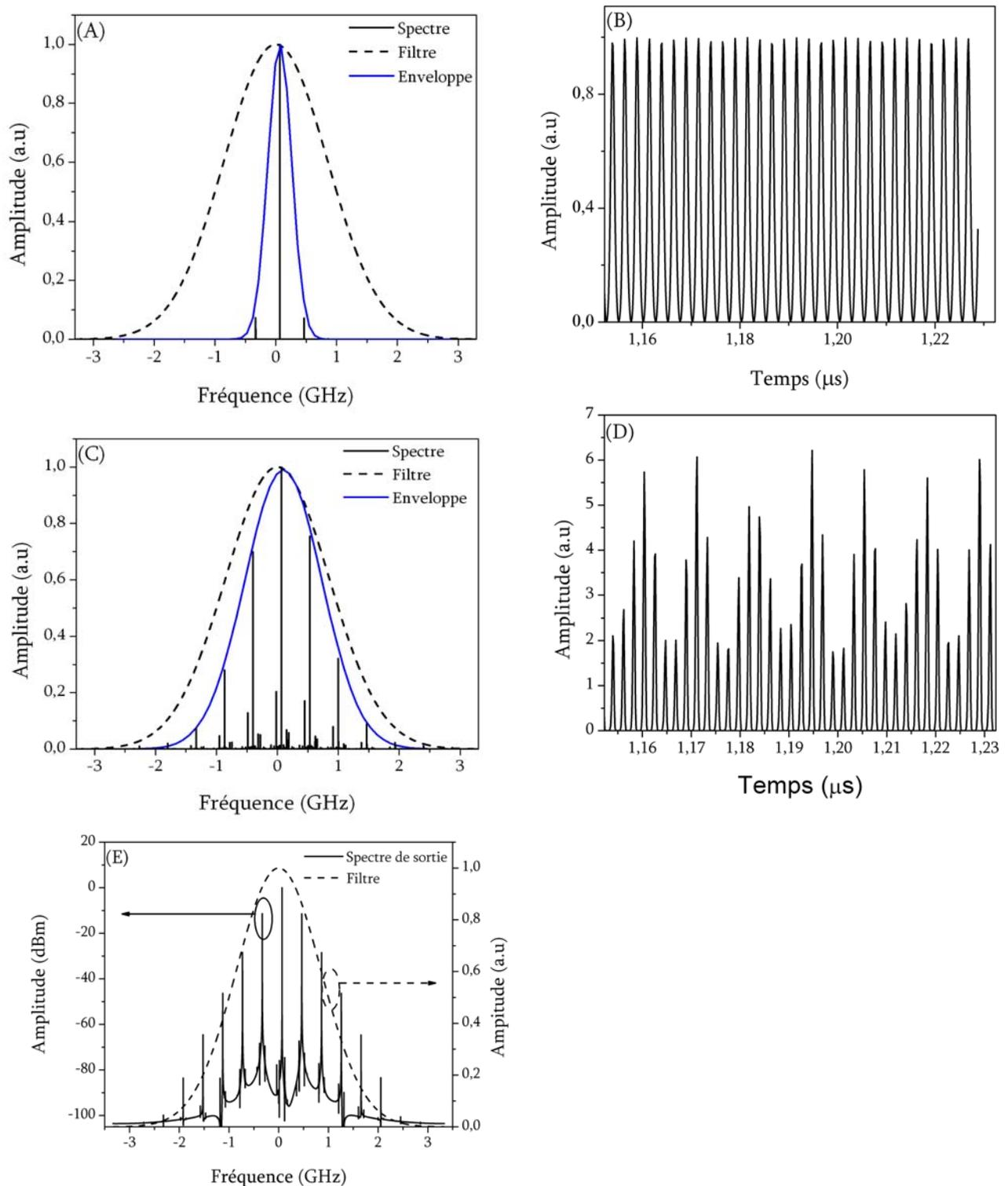
Figure 6.39 : Simulation pour les deux fréquences de modulation. (A) et (B) Spectre et trace temporelle pour  $f_{m2}$ . (C) et (D) Spectre et trace temporelle pour  $f_{m1}$ . (E) Représentation du spectre du laser utilisant la fréquence  $f_{m2}$  dans une échelle logarithmique.
