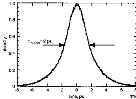
Figure 1.11 : Impulsion obtenue pas Sousa et al avec une cavité laser sans filtre optique<sup>[14]</sup>.
