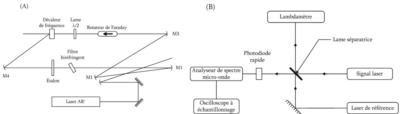
Figure 5.3 : Montages expérimentaux proposés par Littler<sup>[9]</sup>. (A) Schématisation de la cavité laser. (B) Dispositif expérimental d'analyse des propriétés spectrales du laser.
