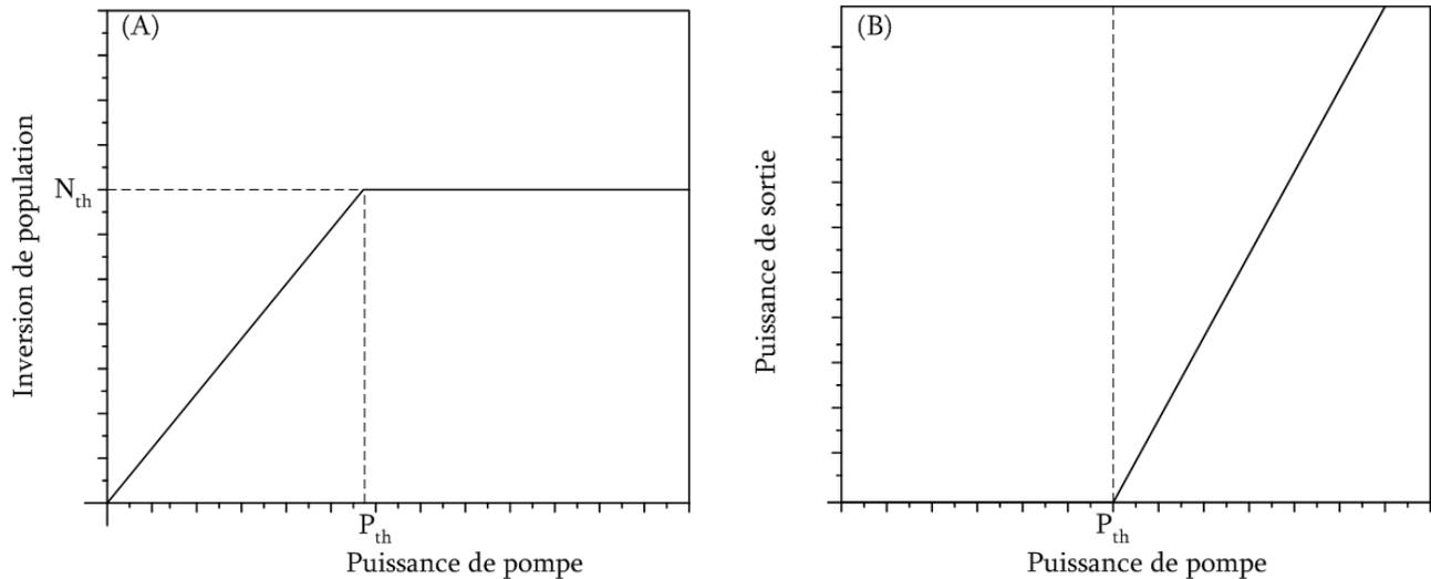
Figure 3.7 : Dynamique d'un laser au niveau de son seuil<sup>[15]</sup>. (A) Évolution de l'inversion de population en fonction de la puissance de pompe. (B) Évolution de la puissance de sortie en fonction de la puissance de pompe.
