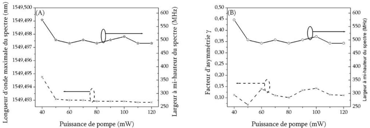
Figure 4.22 : Analyse des différents paramètres du spectre dans le cas où le filtre Fabry-Perot est utilisé
