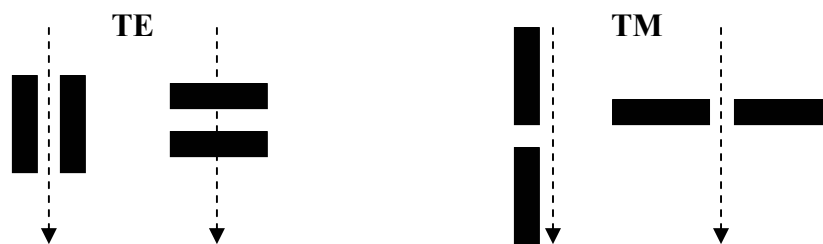
Figure 2.6 : Configurations des antennes radar pour les modes TE et TM. Les flèches en pointillés représentent la direction des profils radar.
