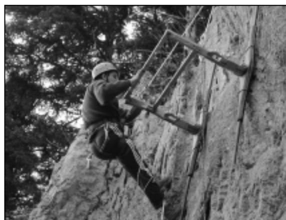
Figure 3.4 : Dispositif GPR en mode réflexion utilisé en falaise pour la réalisation des différents profils verticaux. La photographie de gauche montre les antennes 50 MHz.
