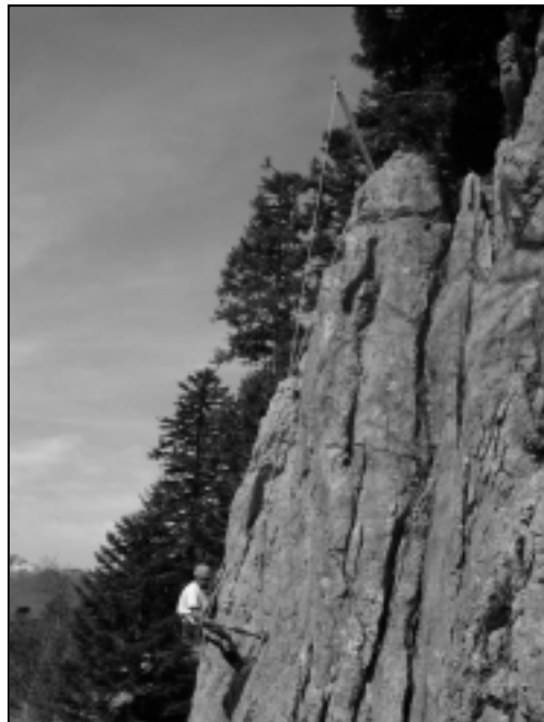
Figure 3.5 : Dispositif GPR en mode transmission utilisé en falaise. Ce dispositif est utilisé pour la tomographie radar.
