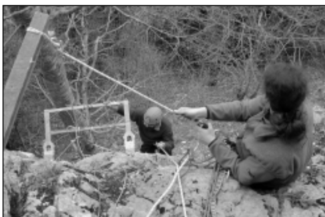
Figure 3.4 : Dispositif GPR en mode réflexion utilisé en falaise pour la réalisation des différents profils verticaux. La photographie de gauche montre les antennes 50 MHz.
