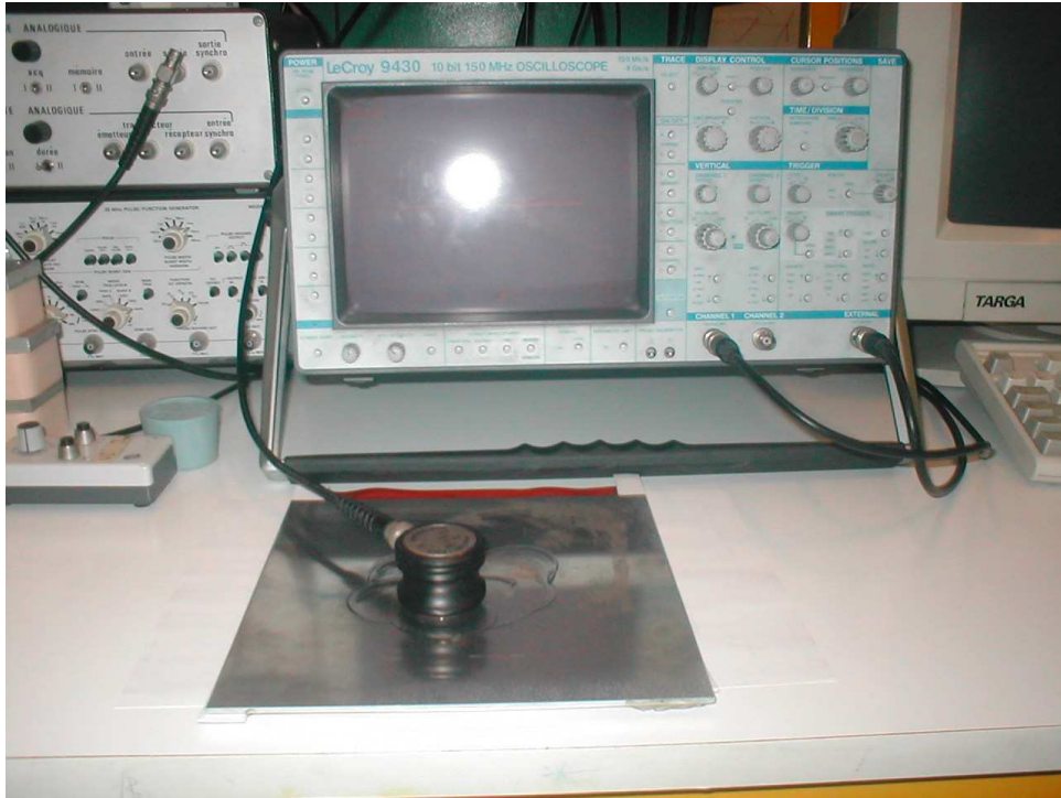
FIG. A.5 – Dispositif expérimental pour les tests ultrasonores en contact.
