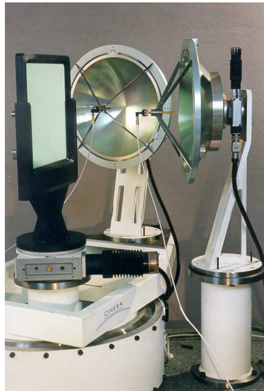
Figure III.B-17 : Banc BACCARAT dans la bande 26,5\text{ GHz} à 60\text{ GHz} dans la configuration réflexion
