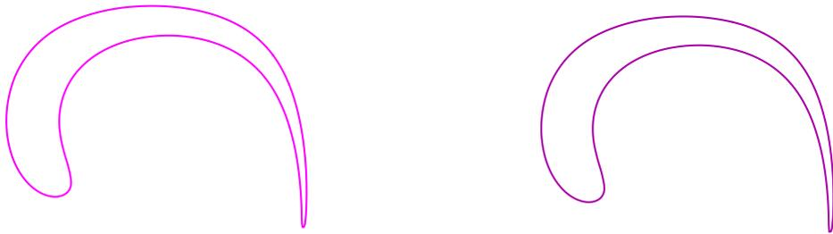
Figure 3.30 : *Comparaison de la position de l'interface avec trois niveaux fins (gauche) et sans AMR sur un maillage fin équivalent (droite), sur un aller-retour de  $t = 6.3s$ .  $\Delta t = 0.0009s$ .*
