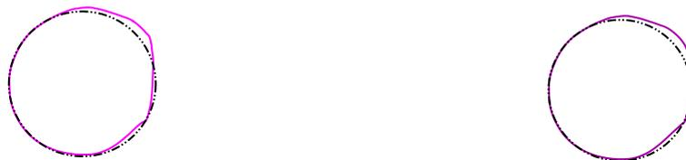
Figure 3.33 : Comparaison de la position de l'interface avec trois niveaux fins (gauche) et sans AMR sur un maillage fin équivalent (droite), sur un aller-retour de  $t = 12.6s$ .
