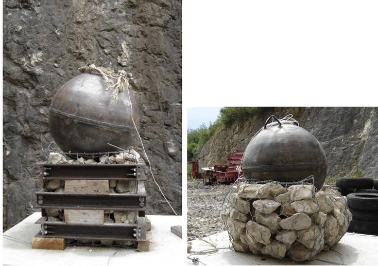
FIG. 4.7 – Impact réel sur cellule de 500 mm de côté : conditions confinée et non confinée.
