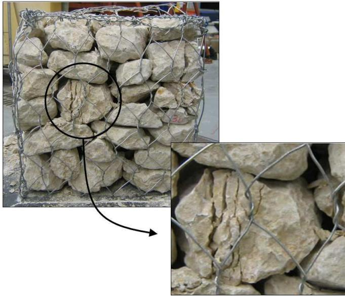
FIG. 4.34 – *Pierres fracturées après un essai de compression confinée sur cellule  $500 \times 500 \times 500 \text{ mm}^3$ . Dans cette configuration, la pierre a cassé en condition uniaxiale de compression.*
