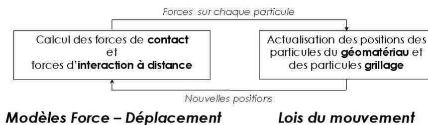
FIG. 2.3 – Cycle de calcul MED avec prise en compte de la modélisation du grillage. Les forces d'interactions des particules de grillage sont calculées au même instant que les forces de contact et sont ajoutées au bilan des forces final.
