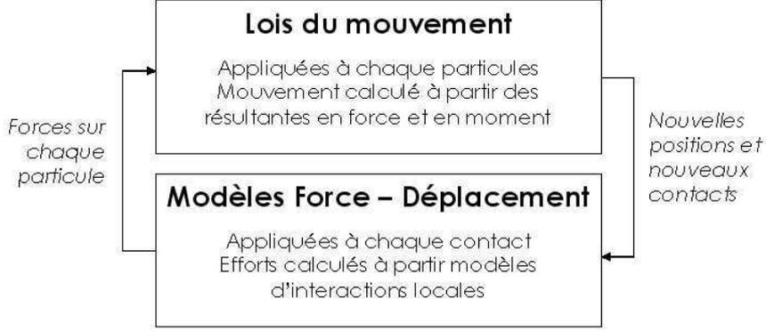
FIG. 1.14 – Cycle de calcul pour une approche MED.
