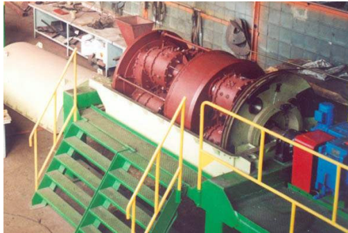
Figure II-7 : Exemple de broyeur planétaire industriel (Source : Société Technics and Technology of Disintegration, TTD)
