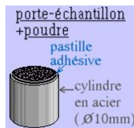
Figure II-15 : Echantillon préparé pour les analyses en microscopie électronique à balayage
