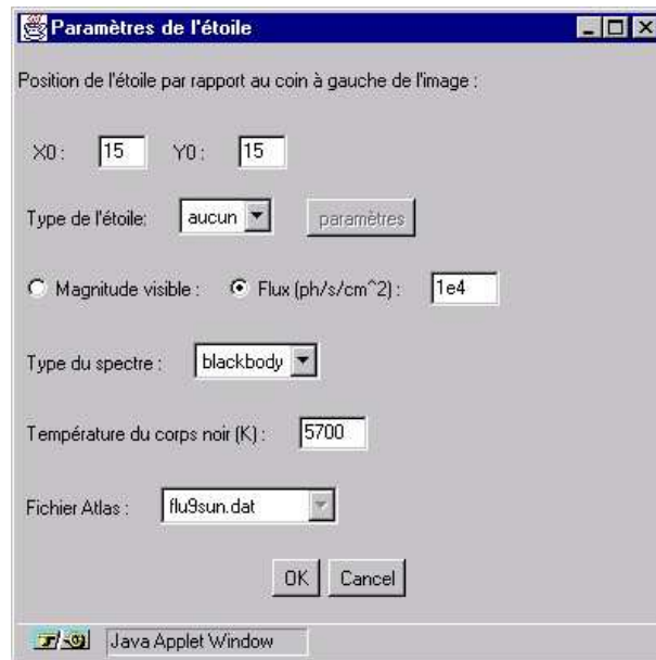
FIG. 8.8 – Interface JAVA : fenêtre pour la configuration des paramètres d'une étoile.
