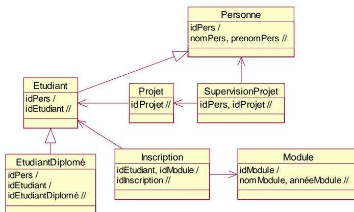
Figure 48 : Nouveau diagramme de l'hyperclasse *hcl\_étudiant*
