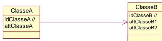
Figure 8 : Représentation d'un lien existentiel entre deux classes
