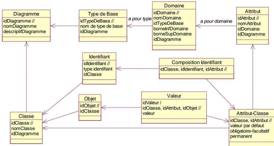
Figure 6 : Méta-modèle *binex* relatif aux classes, aux attributs, aux identifiants et aux objets
