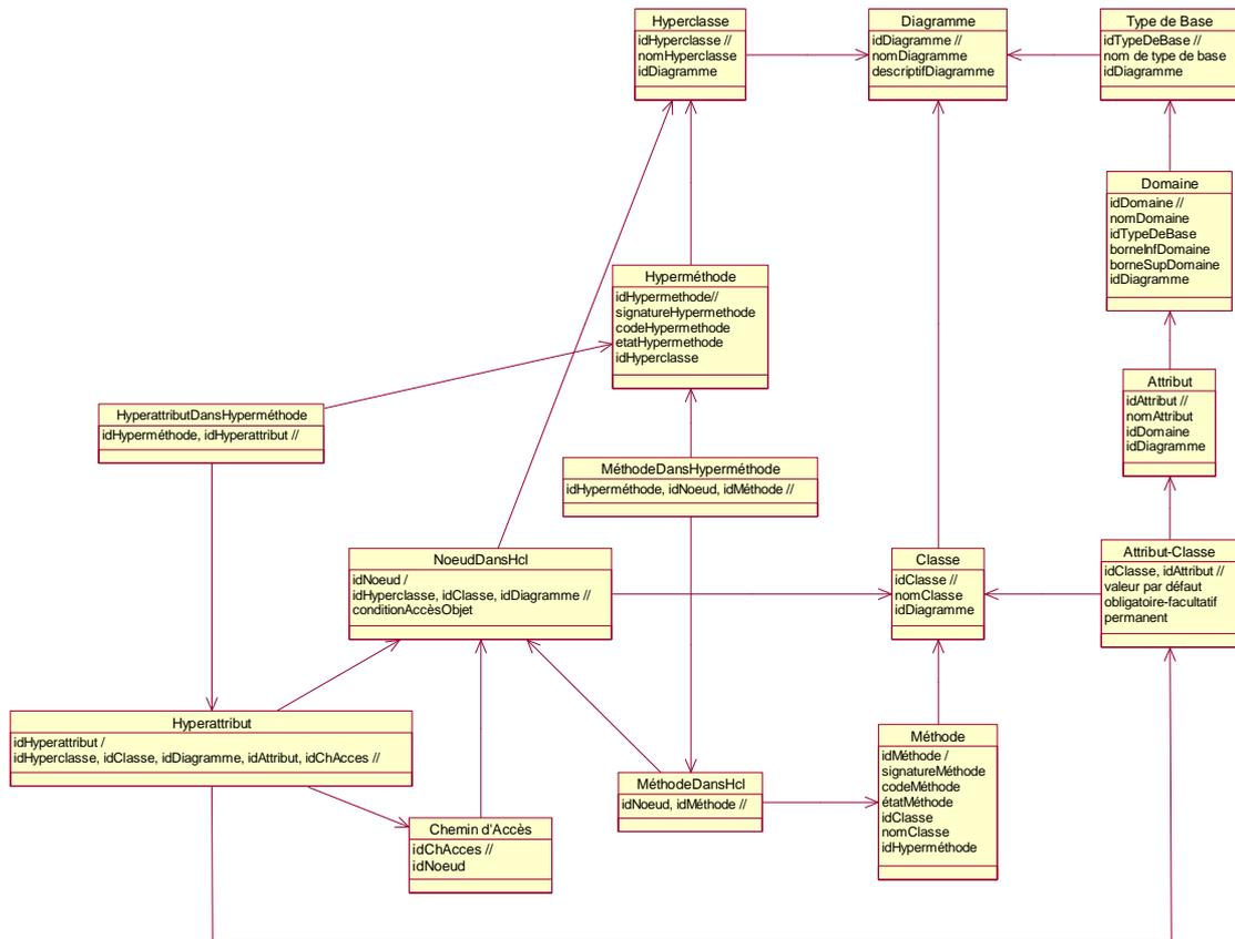
Figure 38 : Modèle d'hyperclasse relatifs aux hyperméthodes
