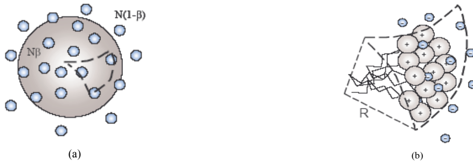
Figure II-3: Micellisation. Schémas d'une micelle. (a) elle peut être considérée vue de loin comme une sphère de rayon R et de charge N\beta ( N étant le nombre de molécules de tensioactif), entourée de N(1-\beta) ions dissociés. (b) le cœur d'une micelle est composé des queues hydrophobes de tensioactif et à l'extérieur de la micelle se trouvent les têtes polaires.
