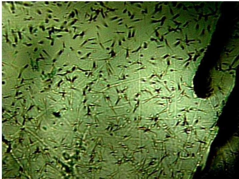
**Figure I-2 : Révélation par attaque chimique des traces de fission de l'uranium induites par des neutrons thermiques dans la fluoroapatite [Carpéna 1 ].**
