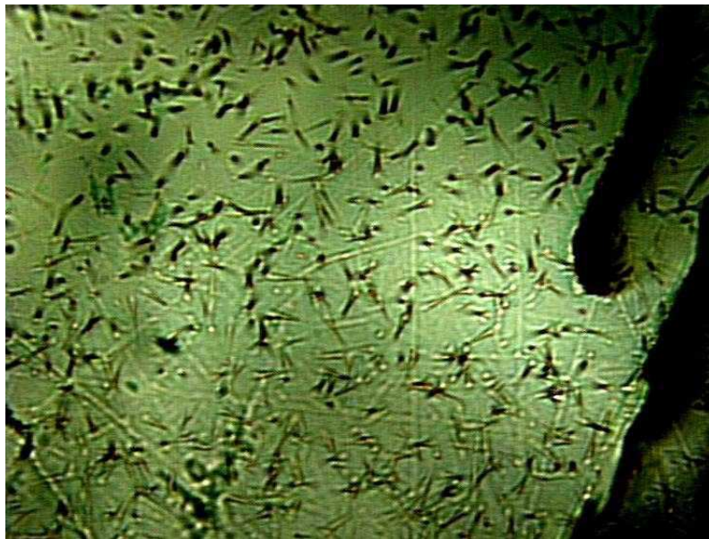
Figure I-2 : Révélation par attaque chimique des traces de fission de l'uranium induites par des neutrons thermiques dans la fluoroapatite [Carpéna 1 ].
