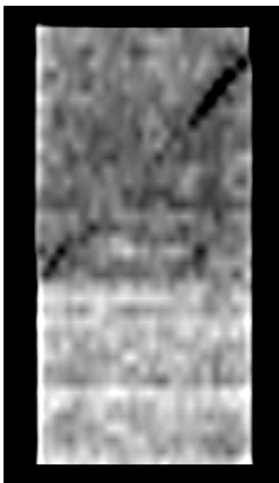
FIG. 4.69 – Coupe verticale de l'échantillon GVR9724. La coupe passe par l'axe de l'échantillon et est perpendiculaire aux traces laissées dans les coupes radiales.
