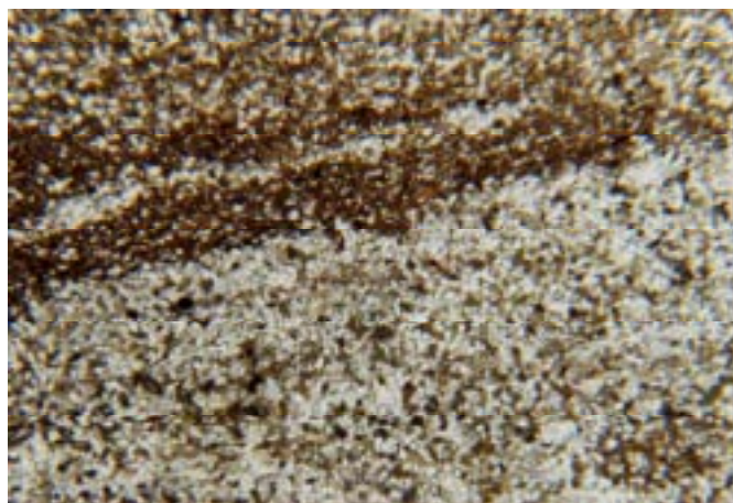
FIG. 5.2 – Lame mince de la siltite, parallèle au sens de carottage, vue au microscope optique à grossissement 10.
