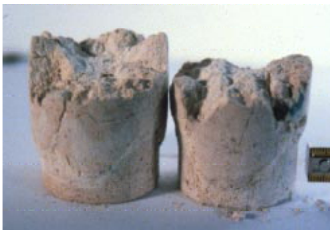
FIG. 1.1 – Exemple des surfaces de rupture observée après compression triaxiale à un confinement de 60 MPa sur un échantillon initialement cylindrique d'un calcaire d'Anstrude.
