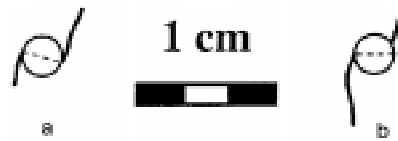
FIG. 5.29 – Représentation schématique de l’amorce des fissures autour du trou, pour l’essai pamar1 (a) et l’essai pamar2 (b).
