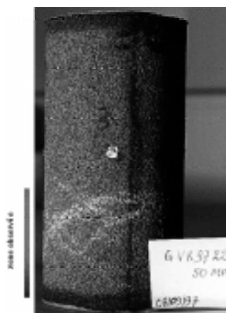
FIG. 4.70 – Echantillon GVR9722, écrasé sous un confinement de 50 MPa. Les coupes présentées ci-dessous appartiennent à la zone signalée par le trait latéral.
