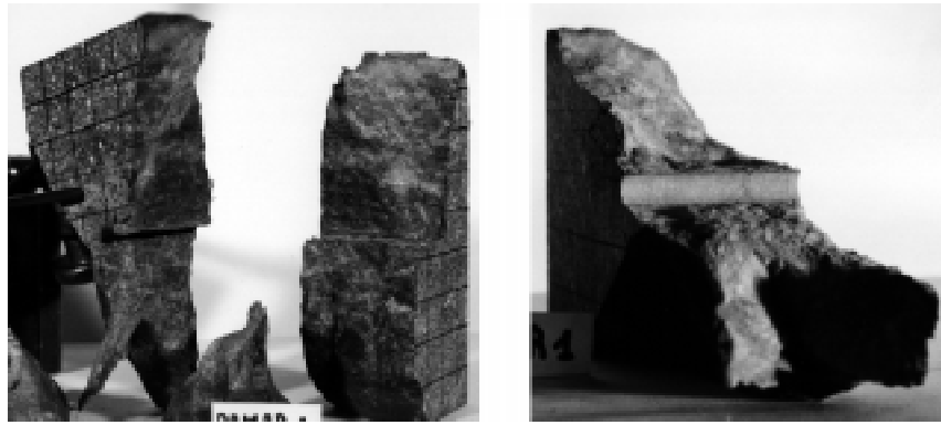
FIG. 5.18 – Pamar1 : photographies des résidus de l'échantillon. La fracture est bien perpendiculaire au plan observé au bord du trou, puis devient inclinée à l'approche de l'extrémité supérieure, du fait du frottement sur le plateau de la presse.
