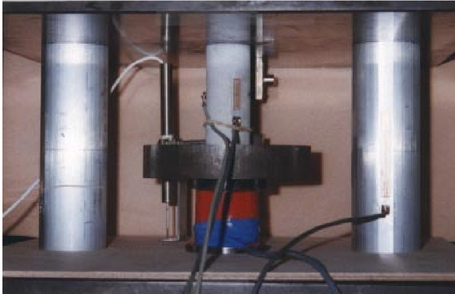
FIG. 5.9 – Installation de rigidification de la presse : deux piliers en parallèle avec l'échantillon monté sur le capteur de force.
