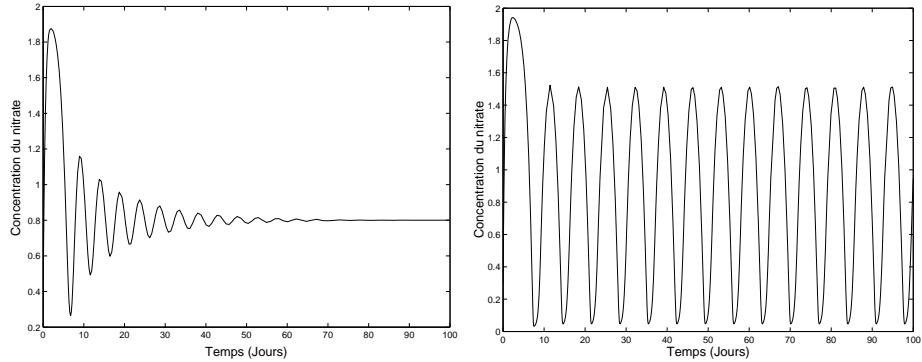
FIGURE 1.7.2. Utilisation d'une loi de commande avec deux sorties  $y(t) = s(t - \tau_i)$  ( $i = 1, 2$ ). Remarquer le ralentissement de la vitesse de convergence vers  $0.8 \mu\text{atg/L}$  (microatomes grammes par litre) et l'apparition d'une solution périodique pour  $\tau$  assez grand.
