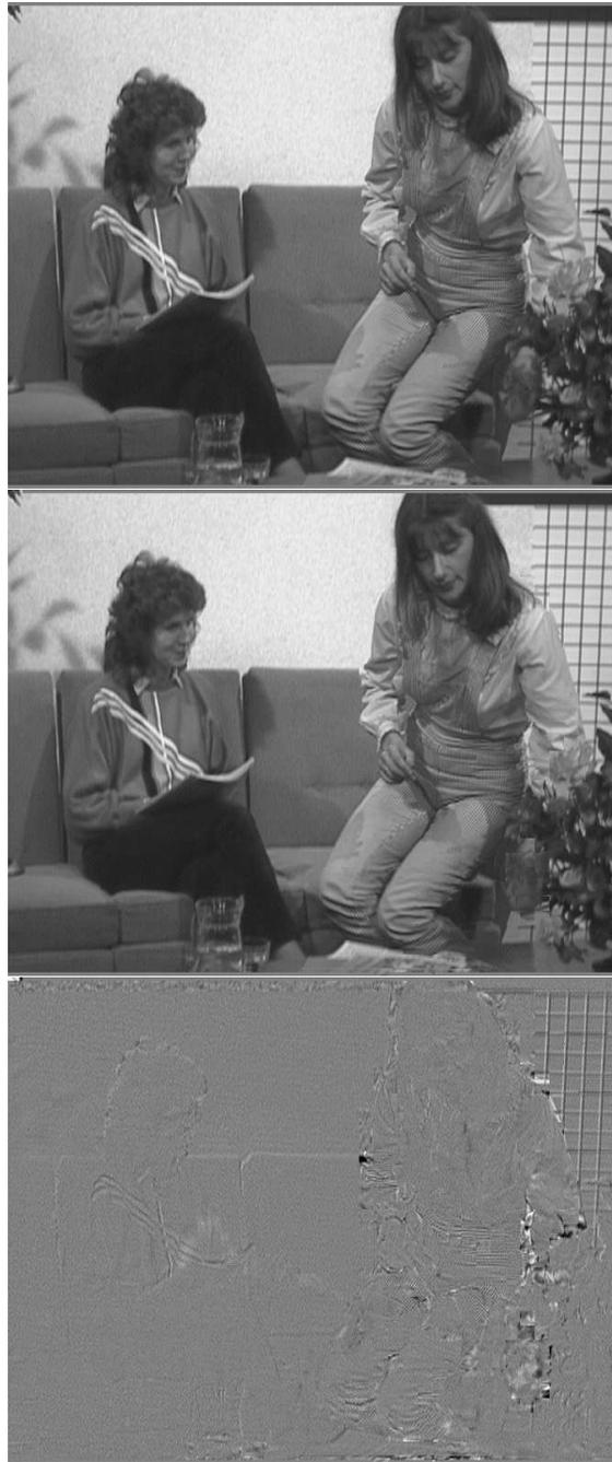
FIG. 1.2 – Séquence «Interview», image 19. Modélisation du mouvement par blocs ( $16 \times 16$  pixels, mouvement de translation). Image originale, image compensée en mouvement, image d'erreur. L'image d'erreur est amplifiée d'un facteur 2 et recentrée autour du niveau de gris 128. L'erreur la plus visible est à l'intersection de l'épaule et des carreaux, où une ligne horizontale a été dupliquée.
