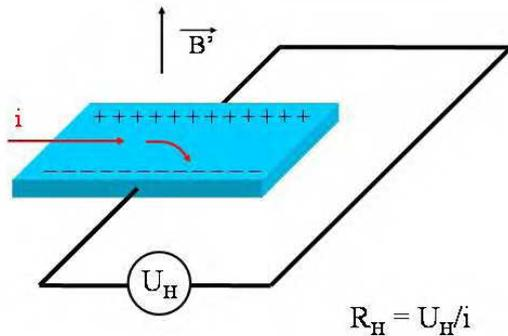
Figure 3: Effet Hall quantique. Un ruban conducteur sous un champ magnétique  $B'$ , et parcouru par un courant  $i$ , développe une tension  $U_H$  perpendiculairement au champ et au courant. En dessous d'une température critique, la quantification des électrons impose à la résistance de Hall  $R_H$  des valeurs discrètes.
