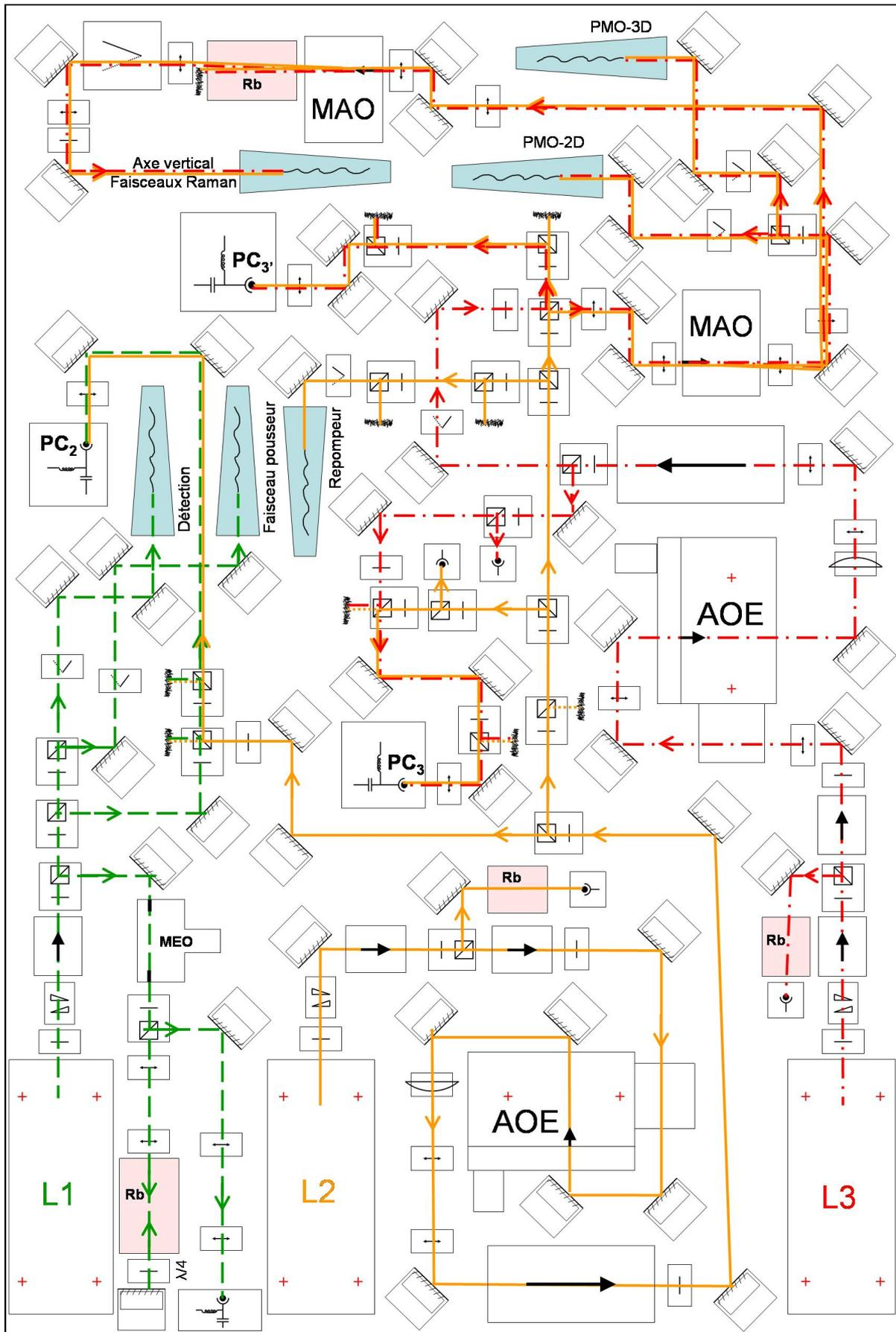
FIG. 4.30 – Schéma du banc optique complet à l'échelle 1/4.
