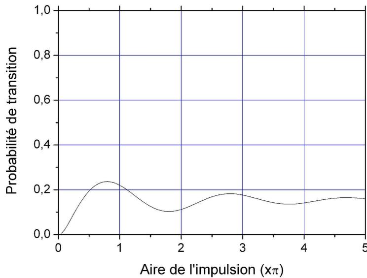
FIG. 5.4 – Oscillation de Rabi de l'impulsion Raman de préparation.
