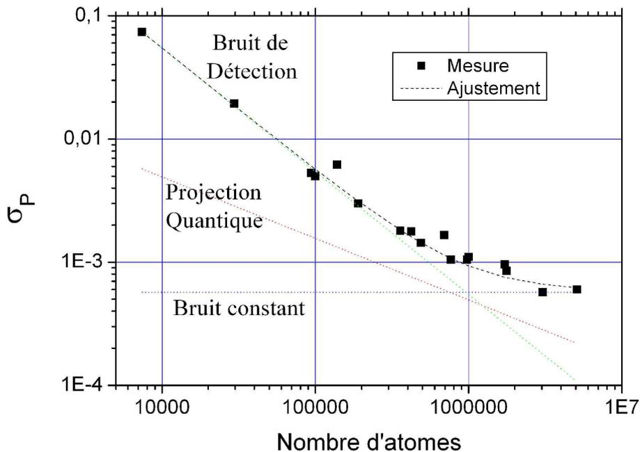
FIG. 5.12 – *Bruit de probabilité de transition en fonction du nombre d’atomes. Les points expérimentaux sont ajustés par un bruit comportant trois composantes : un bruit de détection ajustable, le bruit de projection quantique et un bruit ajustable indépendant du nombre d’atomes.*
