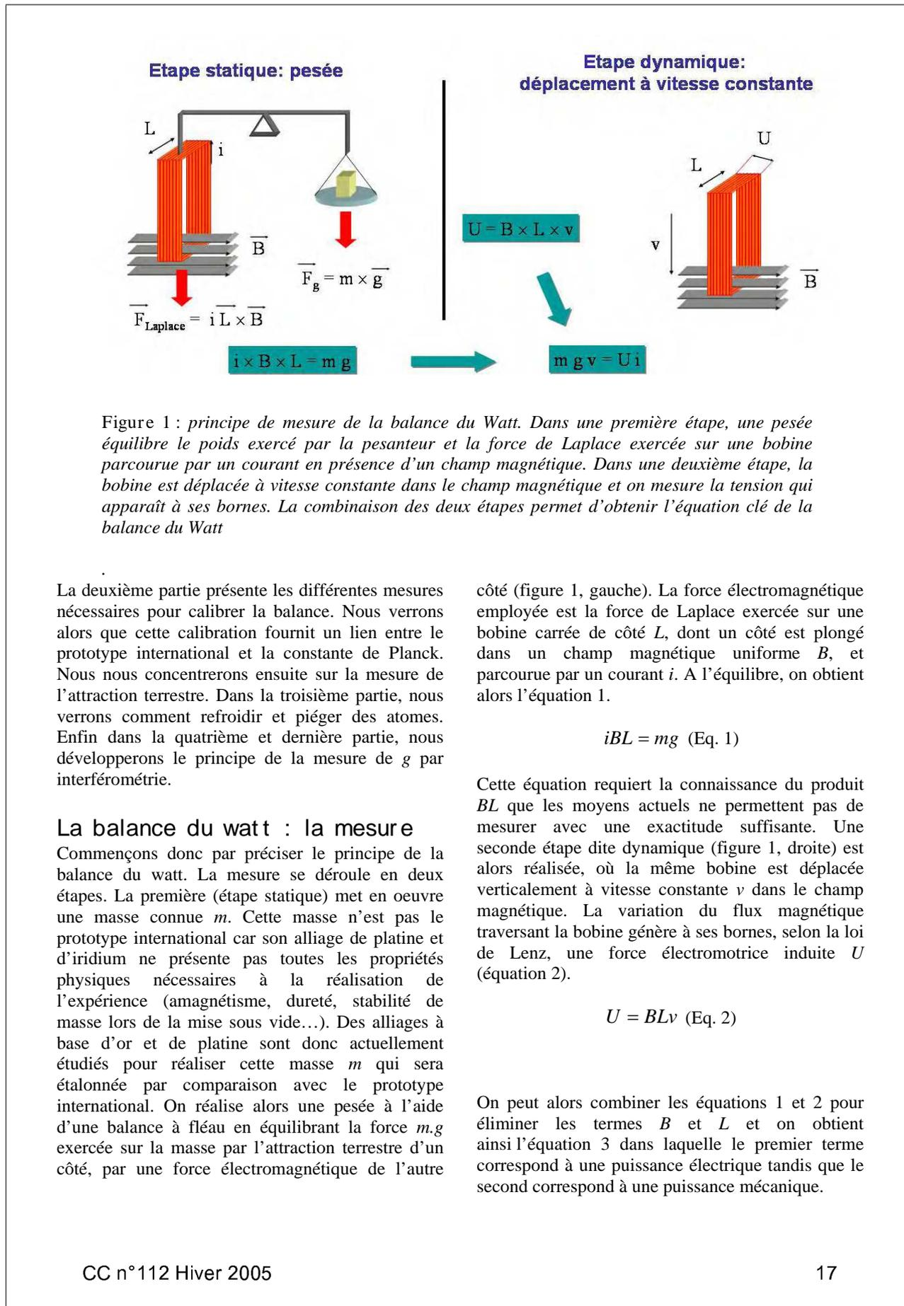
Figure 1 : principe de mesure de la balance du Watt. Dans une première étape, une pesée équilibre le poids exercé par la pesanteur et la force de Laplace exercée sur une bobine parcourue par un courant en présence d'un champ magnétique. Dans une deuxième étape, la bobine est déplacée à vitesse constante dans le champ magnétique et on mesure la tension qui apparaît à ses bornes. La combinaison des deux étapes permet d'obtenir l'équation clé de la balance du Watt
