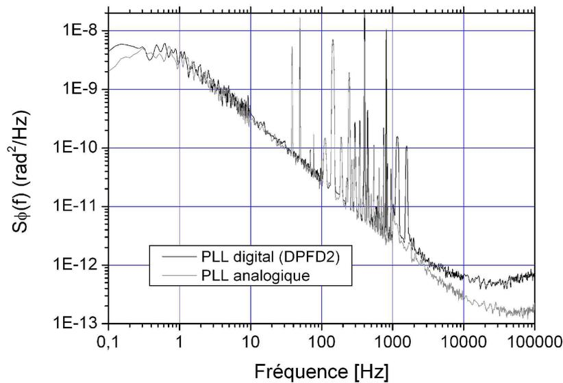
FIG. 4.25 – Densité spectrale de bruit ajouté par la nouvelle chaîne de fréquence à 7.024 GHz, montée avec un asservissement digital. La mesure est réalisée par comparaison de deux chaînes de structures identiques et utilisant un signal à 100 MHz commun. En gris, densité spectrale de bruit mesurée en remplaçant le détecteur DPFD2 par un mélangeur analogique.
