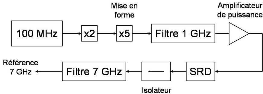
FIG. 4.22 – Première chaîne de fréquence du gravimètre.
