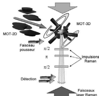
Fig. 1 : Principe de fonctionnement du gravimètre
