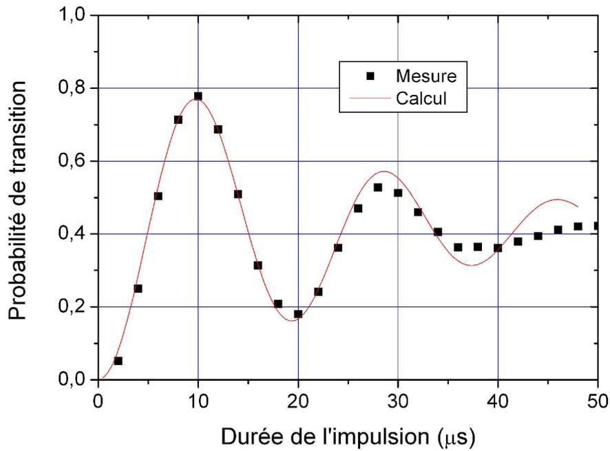
FIG. 5.5 – Oscillation de Rabi mesurée après la préparation de l'état quantique. La courbe en trait plein montre l'oscillation de Rabi prédite par le calcul pour un décentrage  $x_0$  de 3 mm entre les faisceaux Ramans et le nuage atomique.
