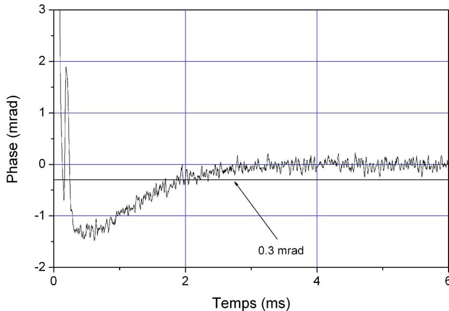
FIG. 4.15 – Signal d'erreur de la phase du laser L3. La boucle d'asservissement de phase est activée à  $t = 0$ , après le saut de 2 GHz. La courbe a été moyennée afin de révéler le comportement transitoire de l'erreur de phase. On observe une décroissance exponentielle de l'erreur de phase.
