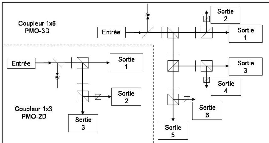
FIG. 4.28 – Coupleurs de fibres 1x6 et 1x3 utilisés respectivement pour le PMO-3D et le PMO-2D. Ils sont constitués d'un ensemble de lames  $\lambda/2$  et de cubes séparateurs de polarisation. Sur chacun des deux coupleurs, une lame prélève 1% du faisceau en entrée pour mesurer la puissance injectée dans le coupleur à l'aide d'une photodiode.
