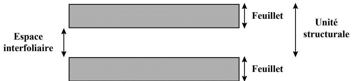
Figure I-5 : Représentation de l'unité structurale d'un phyllosilicate
