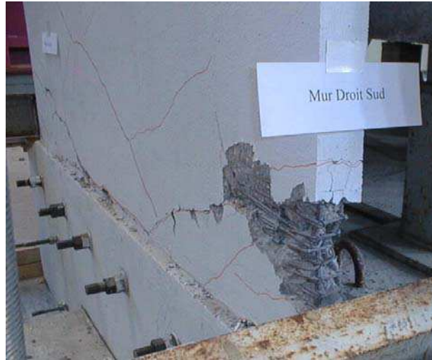
Figure 3.16. CAMUS III - Voile à la fin de l'essai
