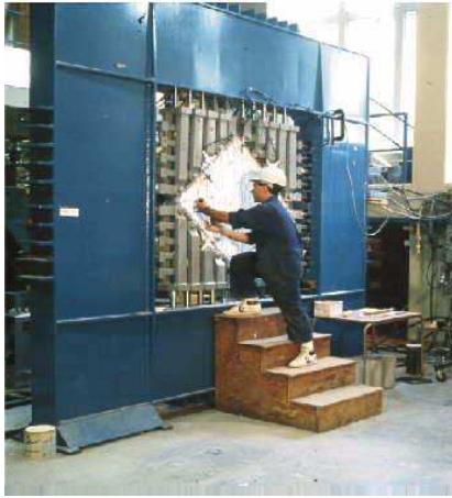
Figure 1.8. Dispositif expérimental pour les essais de cisaillement (Univ. of Toronto)
