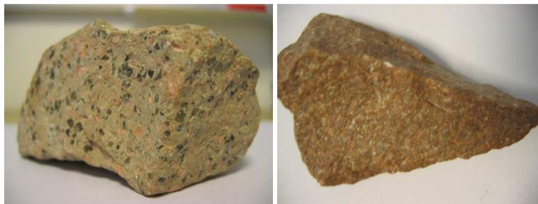
FIG. 1.8 – Photographie de grains de ballast.
