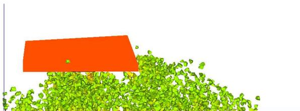
FIG. 10.15 – Grains les plus chargés après le second chargement.
