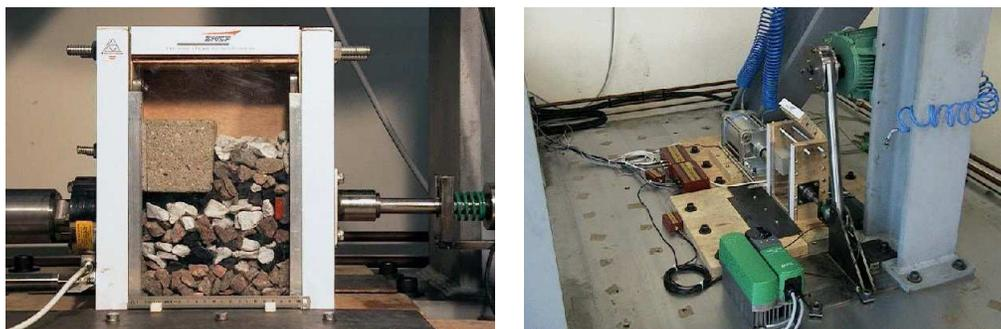
FIG. 2.3 – Banc d'essais BOUBA (**B**ourrage du **b**allast).
