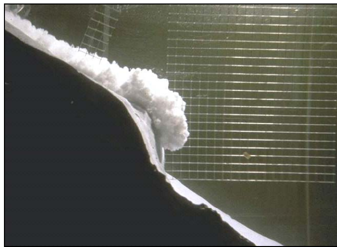
Figure 1.4 : simulation d'avalanche aérosol en canal noyé – Cemagref – P. Béghin
