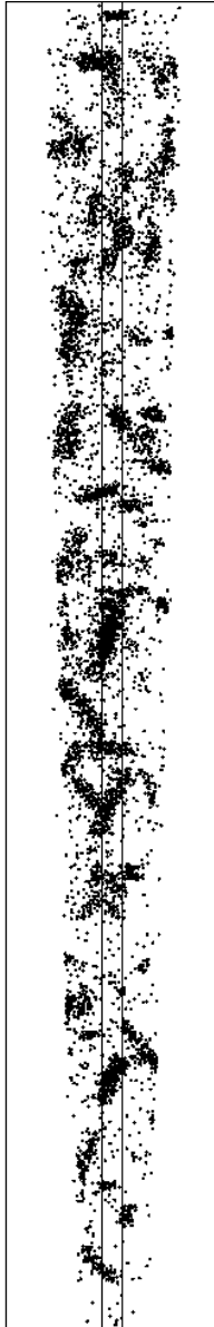
FIG. 1.3 – Image de MET haute résolution obtenue sur une aiguille de \beta'' par Andersen et al. [1998]. Le faisceau est orienté dans une direction [001] de l'aluminium.
