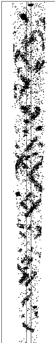
FIG. 4.1 – Représentation schématique de l'effet dans le plan (x,y) de champs d'évaporation multiples dans le précipité. Quatre zones différentes vont apparaître.
