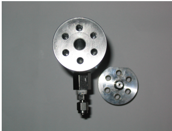
FIG. 6.2 – Cellule utilisée pour étudier les effets inertiels.
