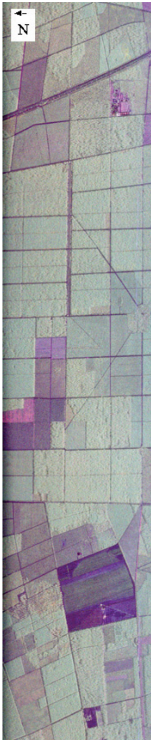
FIG. 2.4 – Carte de \sigma_0 polarimétrique normalisé, associé à la base lexicographique, des données acquises en bande L sur la forêt de Nezer. La passe est effectuée dans la direction Est-Ouest.
