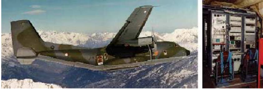
FIG. 1.13 – Système RAMSES visible dans l'ouverture de la porte sur le flanc du Transall (à gauche) et baies numériques permettant la gestion et le contrôle de l'acquisition durant le vol (à droite).
