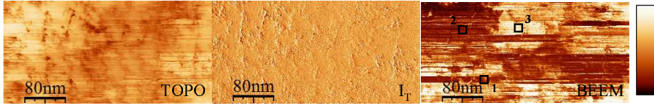
FIG. 3.20: Mesures simultanées des signaux topographiques, du courant tunnel et du BEEM sur l'échantillon D(\text{Si}/\text{Au}7.5\text{-evap}) (mesure m8). Des spectres BEEM ont été enregistrés aux emplacements marqués par les chiffres 1, 2 et 3 sur l'image BEEM. N-B : (Z)15.17 \text{ nm} ; (I_T)0.34\text{-}1.38 \text{ nA} ; (I_B)0.11 \text{ nA} .
