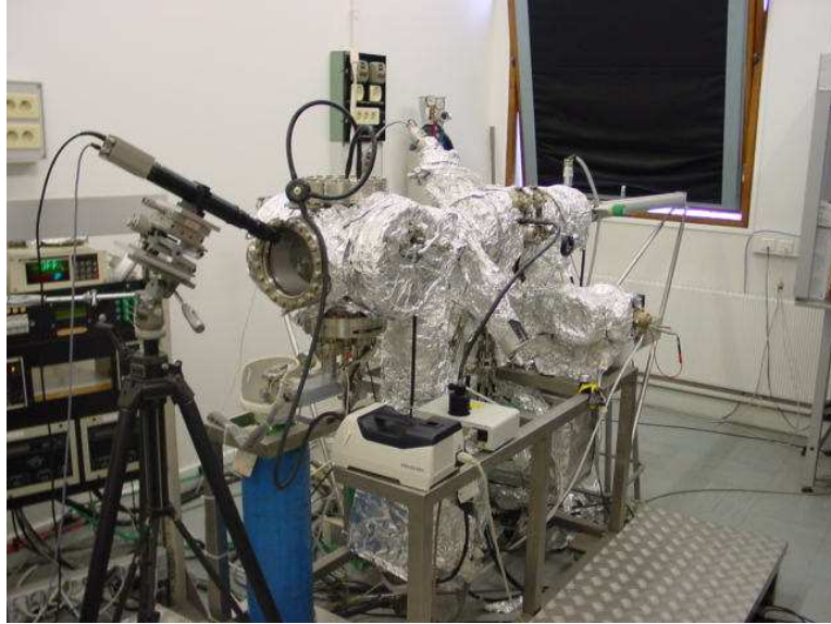
FIG. 2.1: Vue globale de l'enceinte ultra-vide du STM. Au premier plan on aperçoit la chambre 1 (STM) avec le système de visée pour engager la pointe dans la zone de l'échantillon à étudier (fenêtre BEEM).
