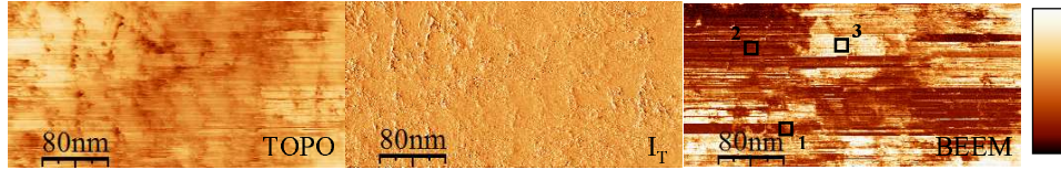
FIG. 3.20: Mesures simultanées des signaux topographiques, du courant tunnel et du BEEM sur l'échantillon D(\text{Si}/\text{Au}7.5\text{-evap}) (mesure m8). Des spectres BEEM ont été enregistrés aux emplacements marqués par les chiffres 1, 2 et 3 sur l'image BEEM. N-B : (Z)15.17 \text{ nm} ; (I_T)0.34\text{-}1.38 \text{ nA} ; (I_B)0.11 \text{ nA} .
