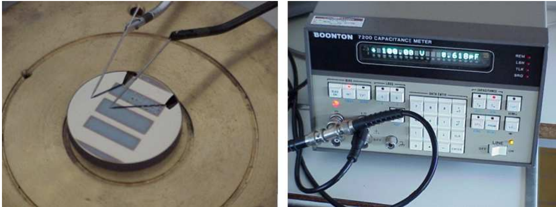
FIG. 3.31 – Photographie des micro-pointes appliquées sur un échantillon, et du capacité-mètre délivrant la tension.
