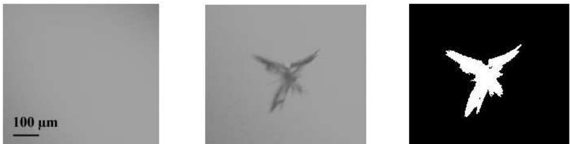
FIG. 2.11 – Détection d'endommagement dans le cas d'un volume (Image avant tir, après tir, et résultat du traitement)
