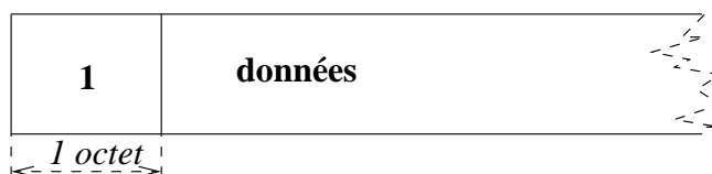
FIG. 4.2 – Le format général d’un message RFB. Il commence par un octet qui précise le type de message suivi par des données qui diffèrent d’un type de message à l’autre.
