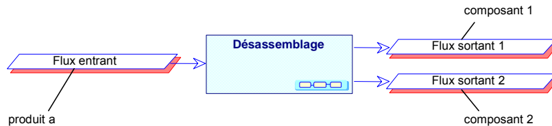
Figure 76 : Séparation (fin de vie) d'un produit en deux composants (début de cycle de vie)
