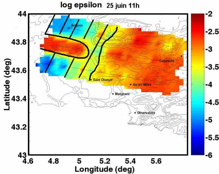
Figure 2.4: Taux de dissipation de l'énergie cinétique turbulente  $\epsilon$  à 800m le 25 juin à 11hTU. La zone hachurée correspond à la troposphère libre, le reste étant dans la CLA.
