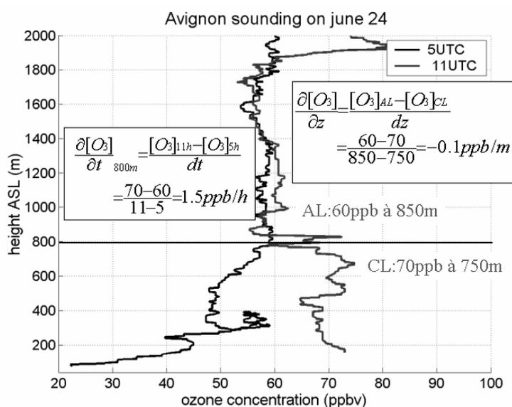
Figure 5.9: sondage d'ozone le 24 juin à 5h et 11h. Exemple de calcul de  $dO_3/dt$  et  $dO_3/dz$
