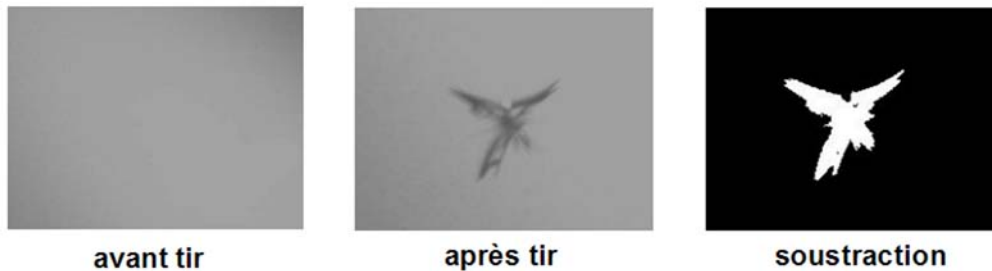
FIG. 2.14 – Détection des endommagements par microscopie optique
