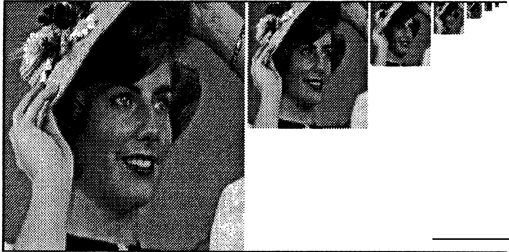
FIG. 16 - Pyramide Gaussienne (avec a=0.4 )
