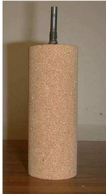
Figure 3.15 : Echantillon d'essais de perméabilité
