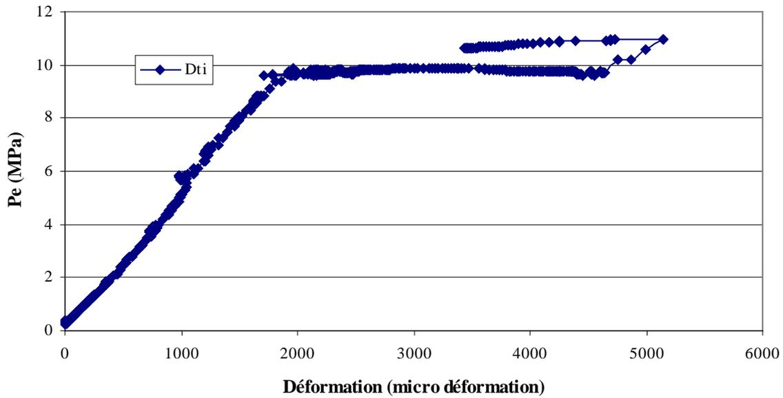
Figure 5.15 : Courbe de Pression externe – Déformation (essai mhccdn9)
