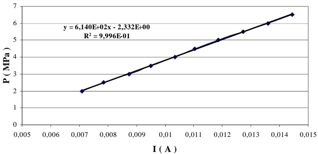
Figure I.3 : Courbe d'étalonnage de capteur de pression
