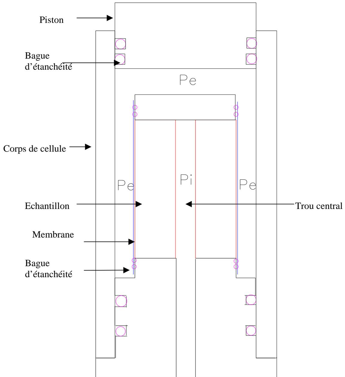
Figure 4.2 : Schéma de la cellule après le montage
