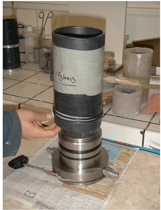
Figure VI.2 : Etape de préparation pendant placer la membrane autour de l'échantillon
