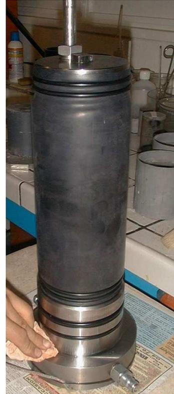
Figure VI.10 : Etape de préparation après avoir placé la membrane avec les o-rings
