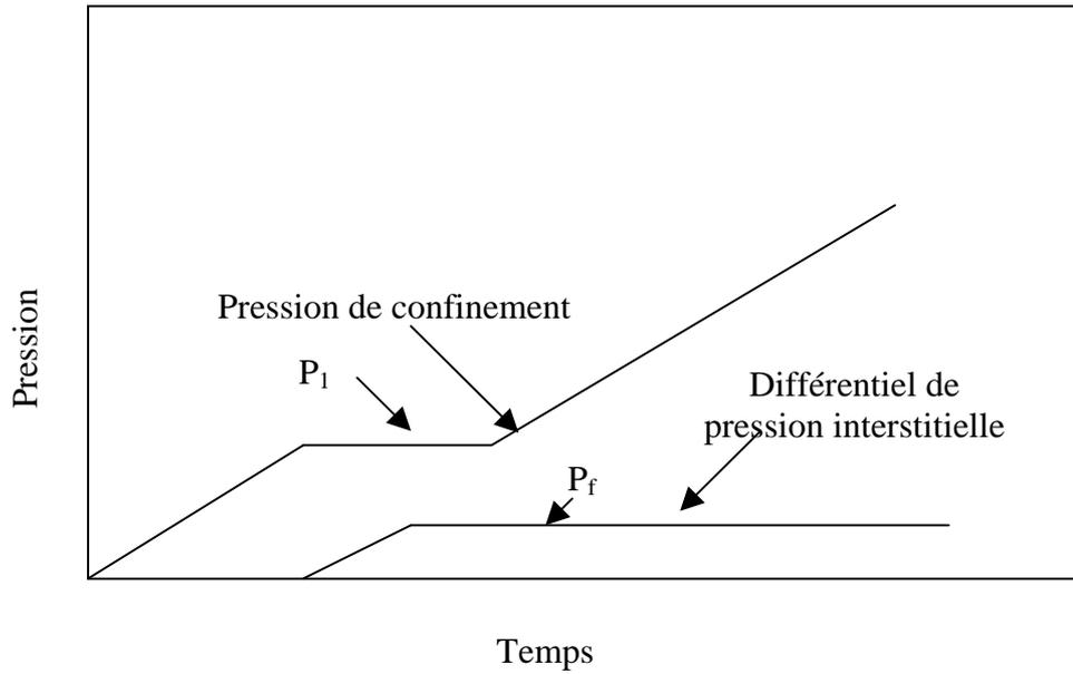
Figure 2.32 : Les étapes d'un essai
