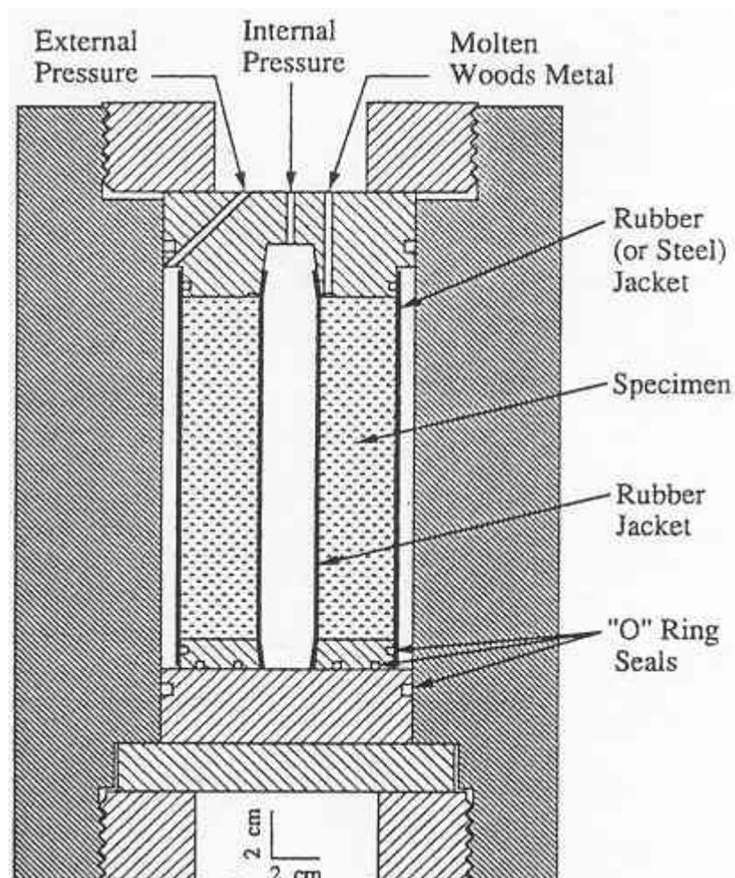
Figure 44. Schéma de la cellule [11].
