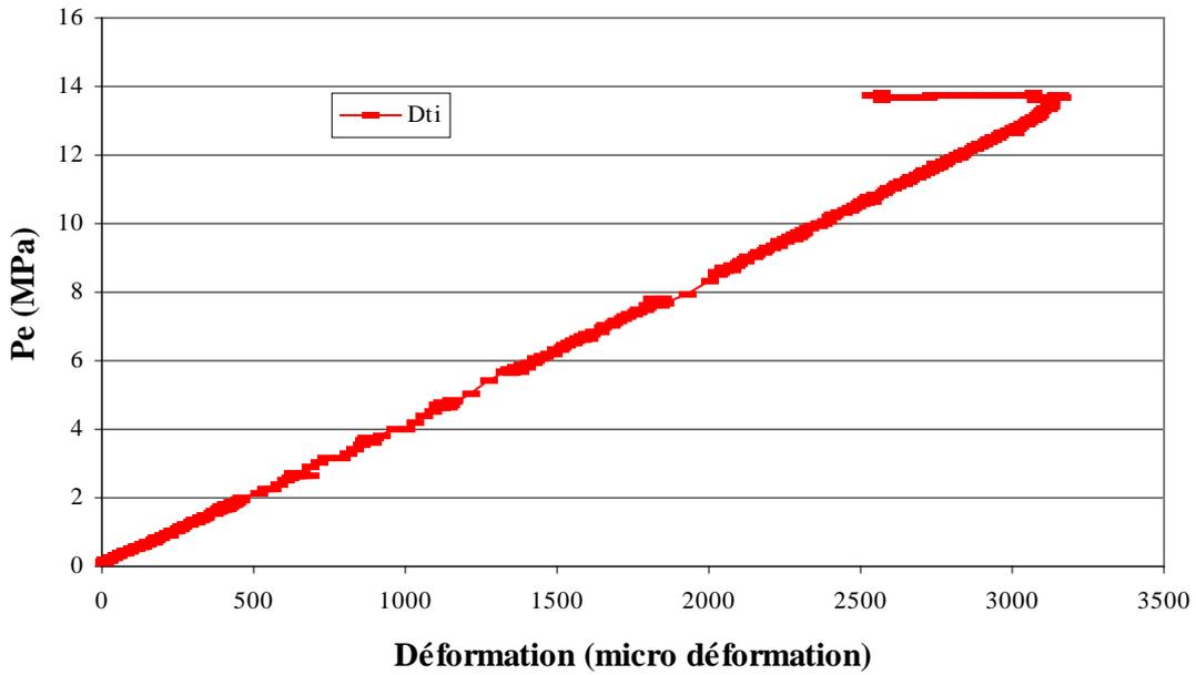
Figure 5.12 : Courbe de Pression externe - Déformation (essai mhccdnn3)
