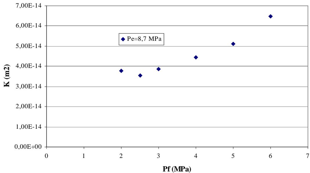
Figure IV.11 : Variations de perméabilité en fonction de la pression interstitielle externe (essai mhccdnn2)
