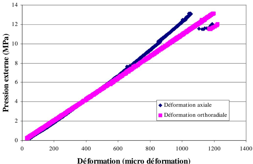
Figure 5.6 : Courbe de pression externe - déformation sur la surface externe de l'échantillon (essai mhcc3)
