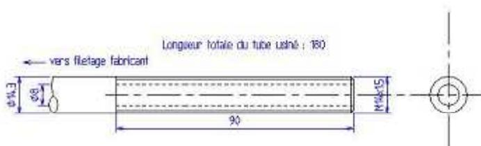
Le tube est fourni en  $\phi$  ext 14,3 (1 1/2"),  $\phi$  int 8, L200, fileté d'un côté
