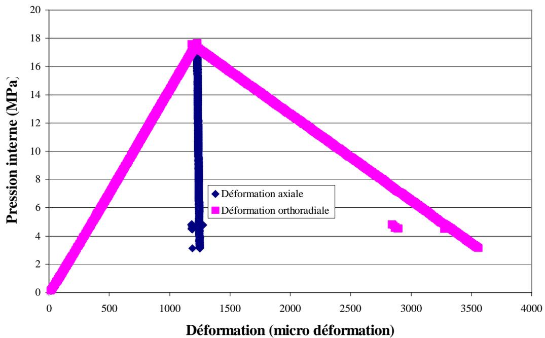
Figure III.4 : Courbe de pression interne - déformation en parois interne (essai mhcc11)
