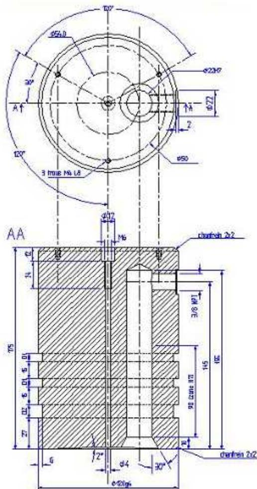
Etanchéité : o-ring 533 - dimensions :
