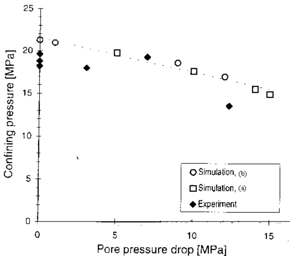
Figure 2.35 : Influence de pression interstitielle sur la pression à la rupture (simulation avec deux chemin de contrainte) [38]
