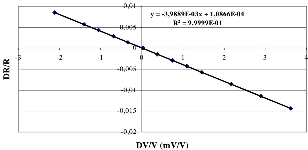
Figure II.3 : Courbe d'étalonnage de voie 2
