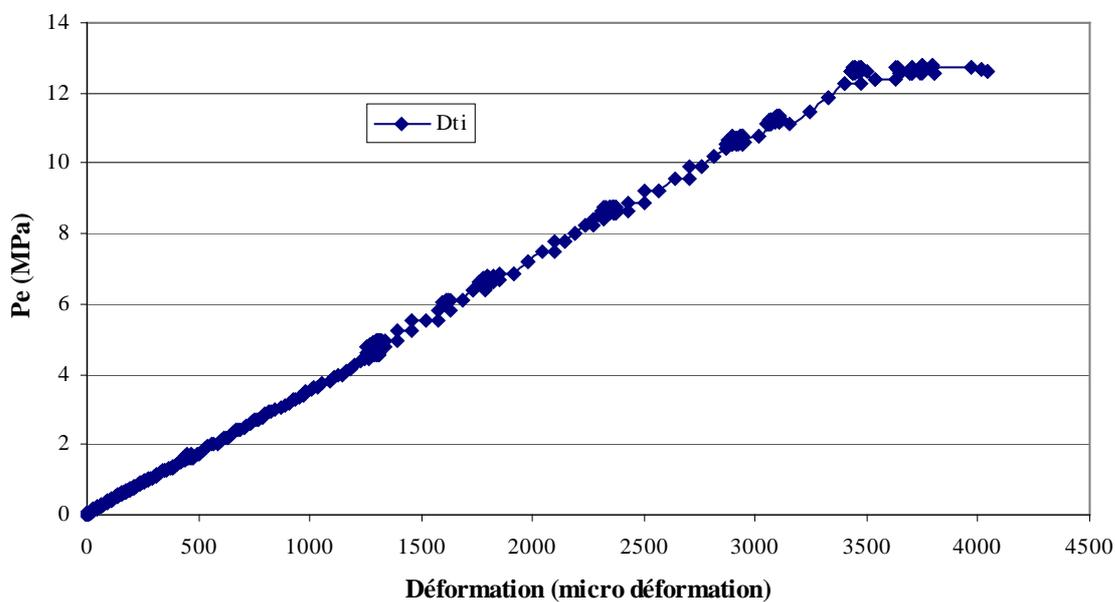
Figure IV.4 : Courbe de pression externe – déformation (essai mhccdn7)
