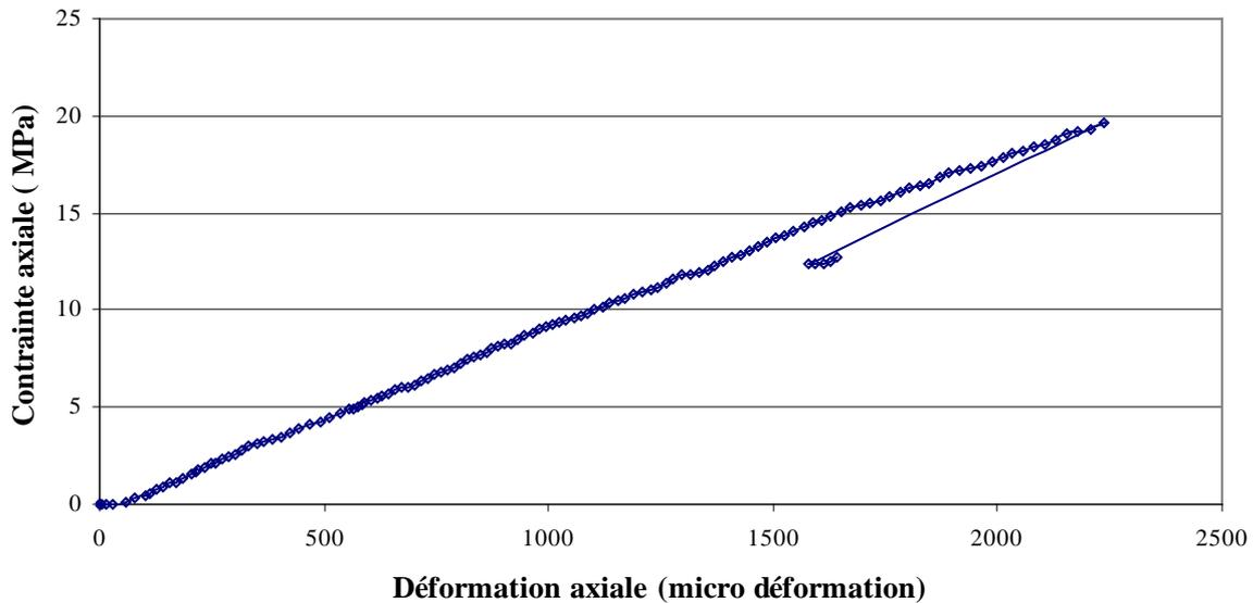
Figure 3.6 : Courbe de contrainte axiale-déformation axiale (essai Mono3)
