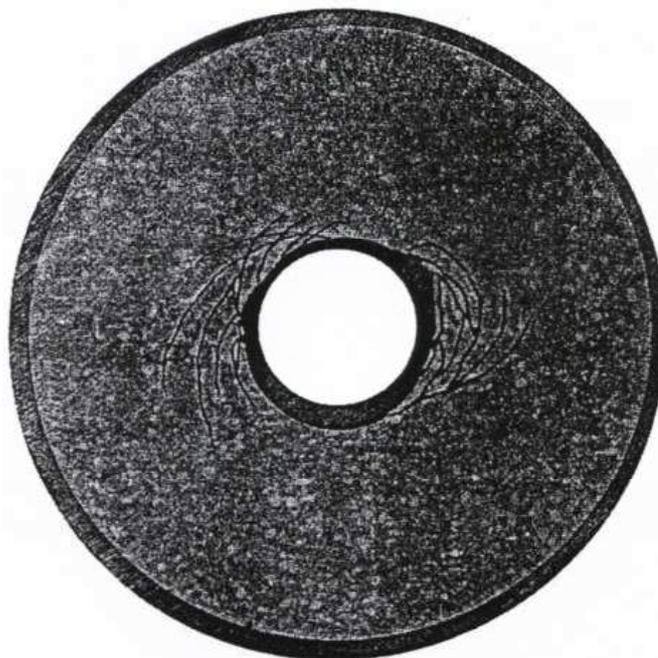
Figure 2.23 : Mode de rupture d'un échantillon cylindrique creux [8]
