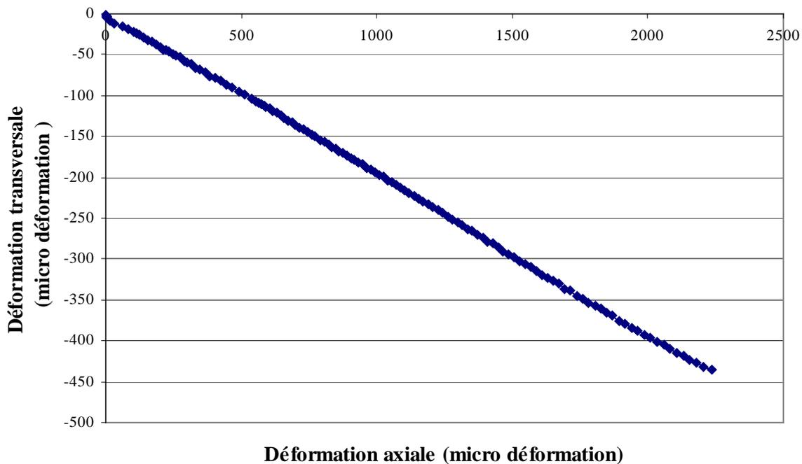
Figure 3.7 : Courbe de déformation transversale-déformation axiale (essai Mono3)
