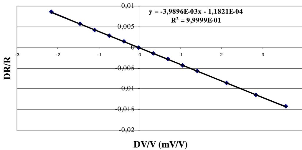
Figure II.4 : Courbe d'étalonnage de voie 3
