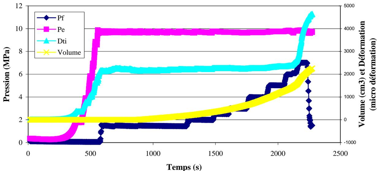
Figure 5.14 : Courbes de pression, déformation et volume en fonction du temps (essai mhccd9)
