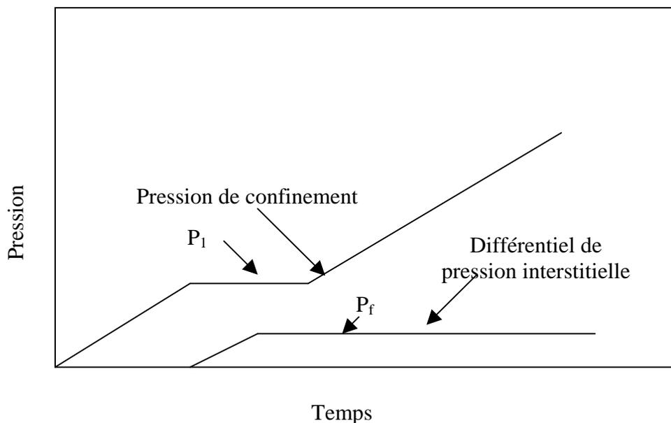
Figure 5.2 : Les étapes d'un essai
