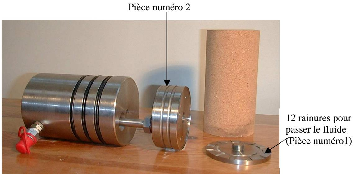
Figure 4.10 : Nouvelles pièces usinées et l'échantillon cylindrique creux
