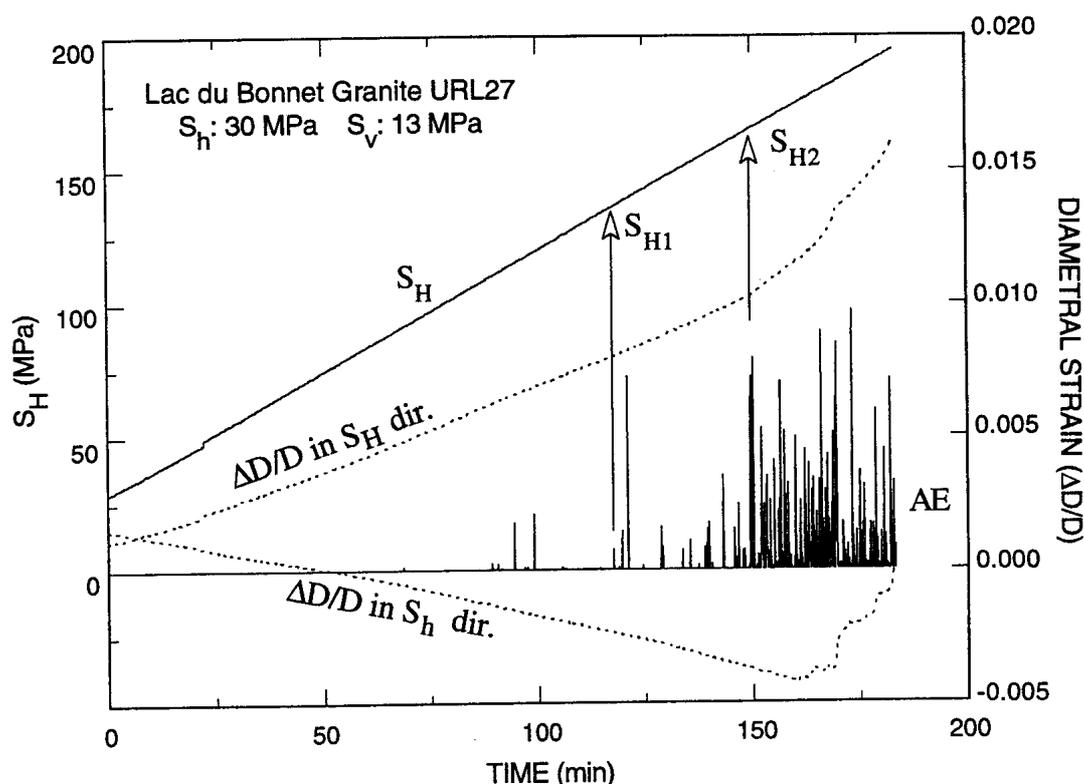
Figure 2.12 : Variation de  $S_H$ , réponse acoustique, déformation diamétrale dans les deux directions  $S_h$  et  $S_H$  en fonction du temps
