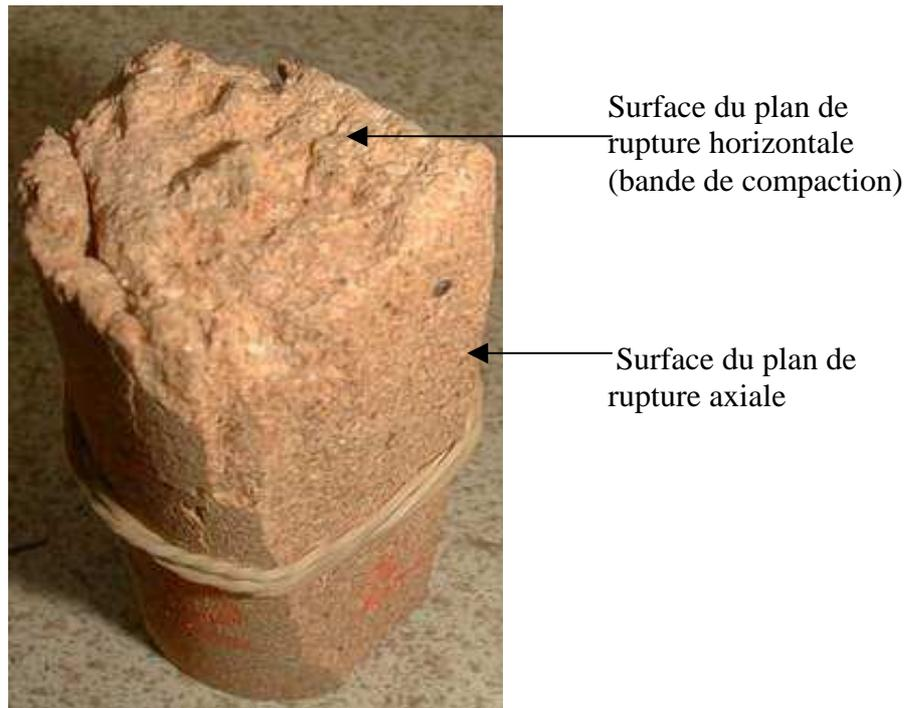
Figure 3.8 : Ruptures axiale et horizontale (échantillon Mono2)
