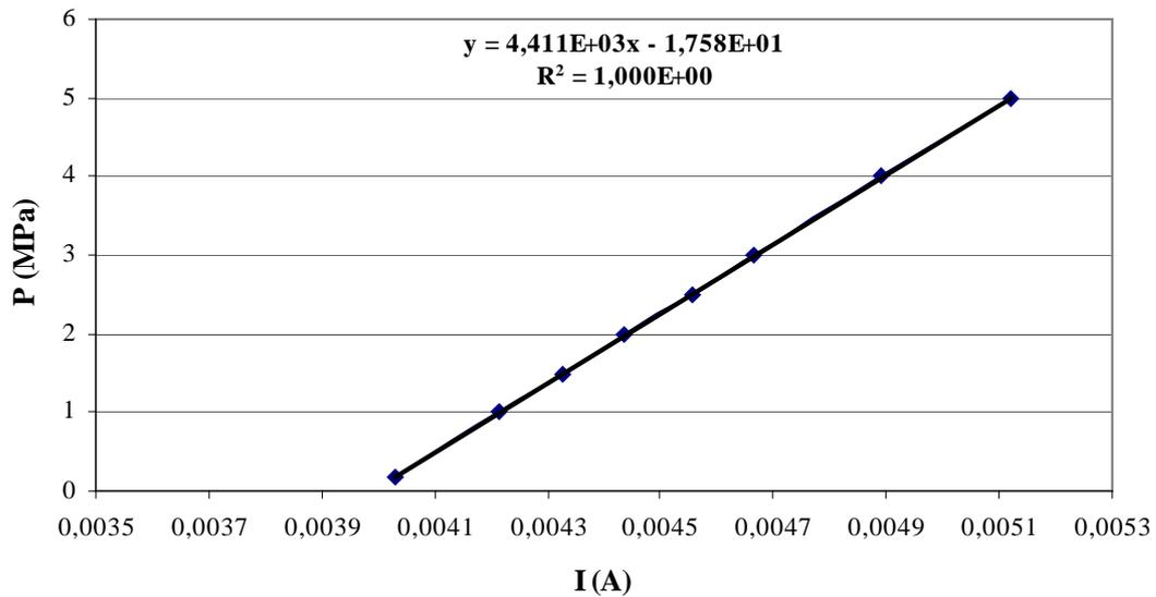
Figure I.1 : Courbe d'étalonnage de capteur de pression
