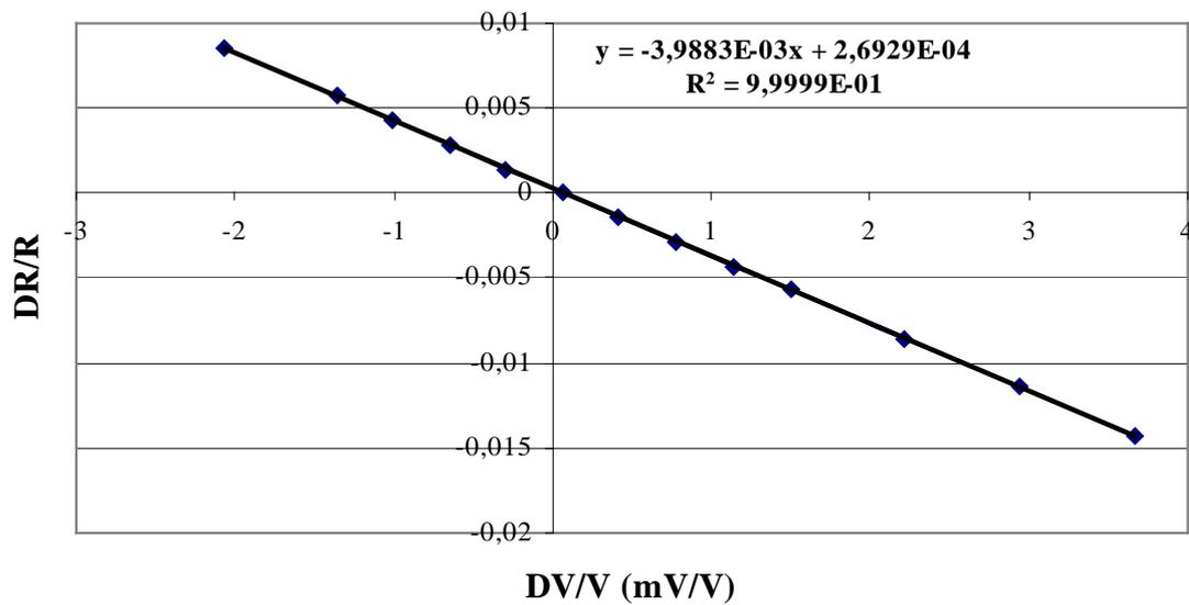
Figure II.1 : Courbe d'étalonnage de voie 0
