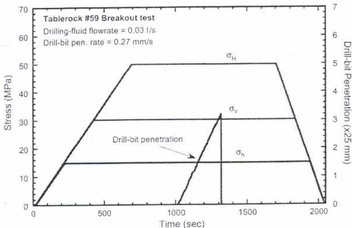
Figure 2.24 : Chemin de chargement-déchargement ; le processus de creusement et chemin de déchargement [20]
