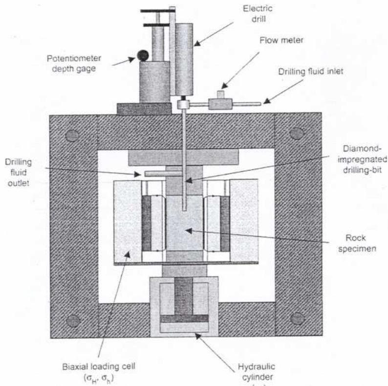
Figure 2.25 : Dispositif expérimental [20]
