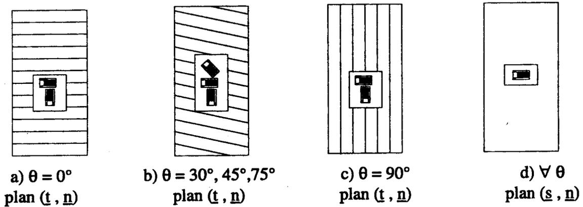
Figure 2.8 : Orientation des jauges collées sur la surface interne des cylindres creux [3]
