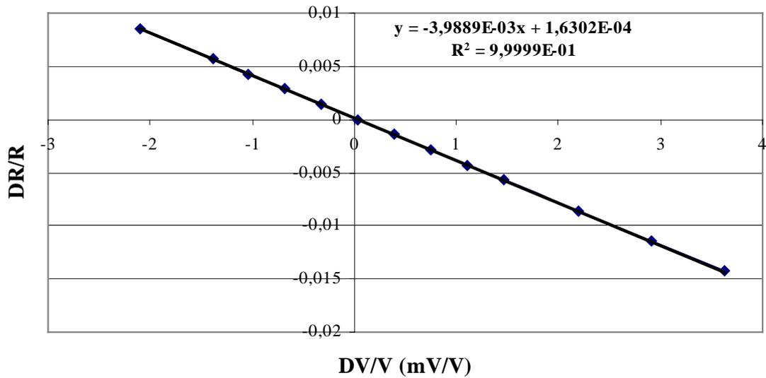
Figure II.2 : Courbe d'étalonnage de voie 1
