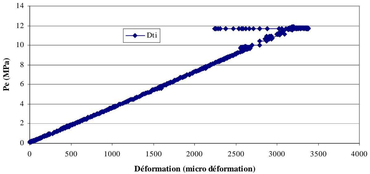
Figure IV.13 : Courbe de pression externe – déformation (essai mhccdn4)
