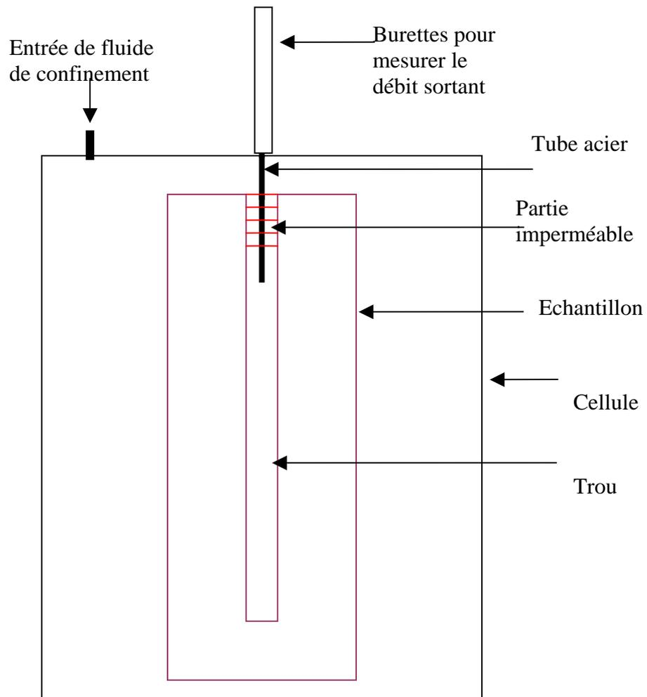
Figure 3.16 : Schéma du dispositif expérimental
