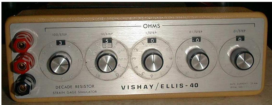
Figure 4.14 : Simulateur Vishay / Ellis-40
