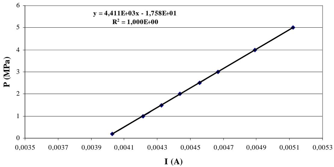
Figure I.2 : Courbe d'étalonnage de capteur de pression
