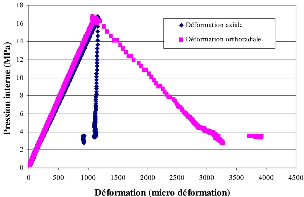
Figure 5.10 : Courbe de pression interne - déformation en parois interne (essai mhcc9)
