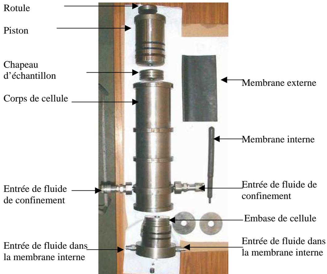
Figure 4.1 : Cellule triaxiale
