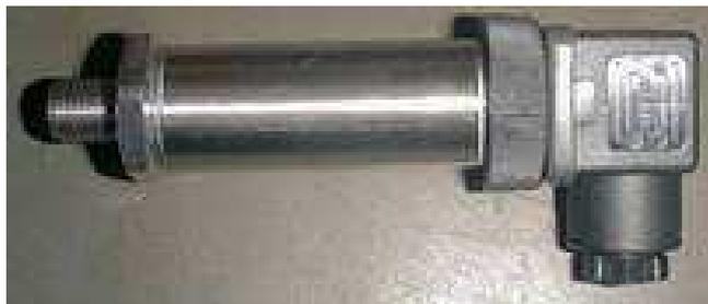
Figure 4.4 : Capteur de pression
