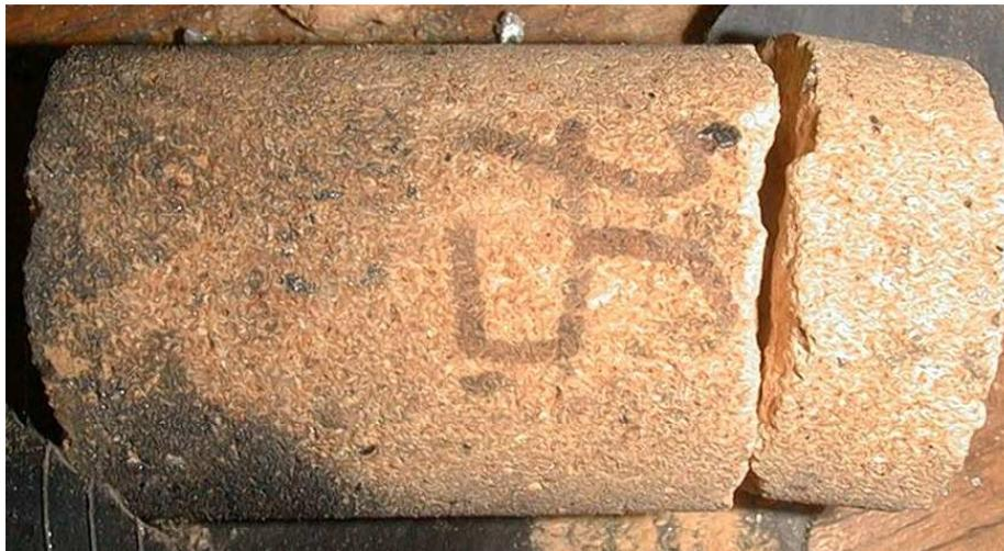
Figure 3.13 : Mode de rupture (échantillon Tri5)
