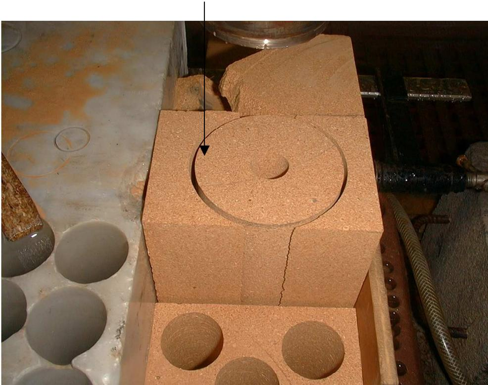
Figure 3.3 :Echantillon après carottage
