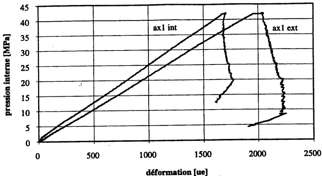
Figure 2.10 : Cylindre creux à  $\theta = 90^\circ$ , d'abord soumis à une pression interne et une pression externe égales, puis à une diminution de la pression interne ; jauge axiale interne et jauge axiale externe sur la face1, plan (t, n) [3]
