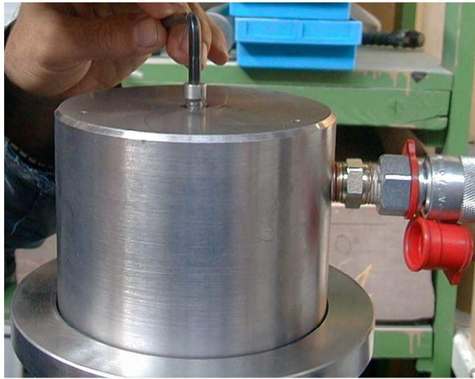
Figure VI.14 : Etape de préparation pendant fermer la vis de purge
