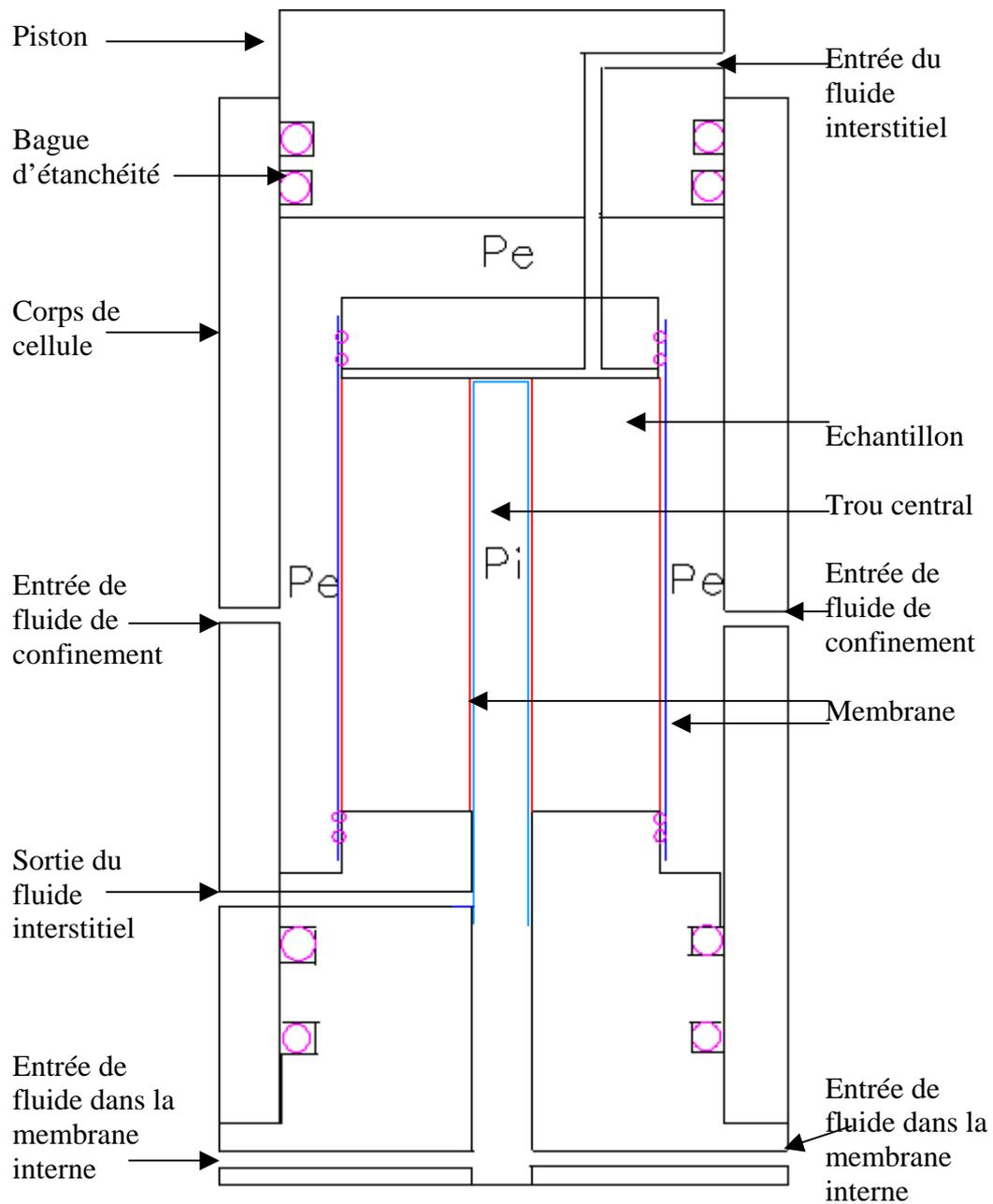
Figure 6.1 : Schéma de la cellule après la modification
