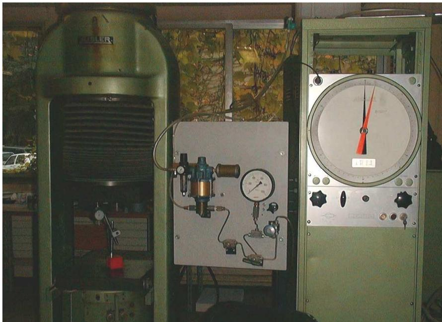
Figure 3.11 : Presse AMSLER (Capacité 3000 kN)
