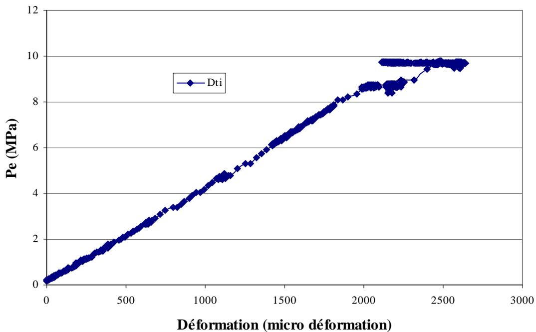
Figure IV.10 : Courbe de pression externe – déformation (essai mhccdn2)
