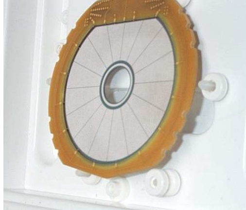
Figure 5.6 Photo du détecteur silicium où la coupure géométrique sur les secteurs supérieurs est visible.
