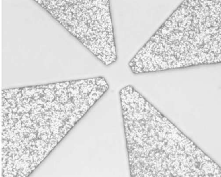
FIG. 1.22 – Image au microscope optique des pôles magnétiques intégrés de de Vries et al. [30]
