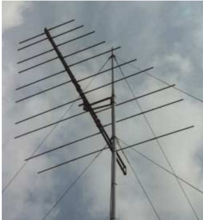
Figure II.1.2 : Vue d'une antenne RACAL-DANA RA943 utilisée.
